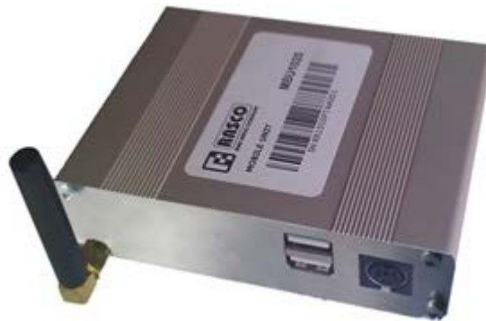
Slika 4.3. GPS-GPRS mobilna jedinica [2]
