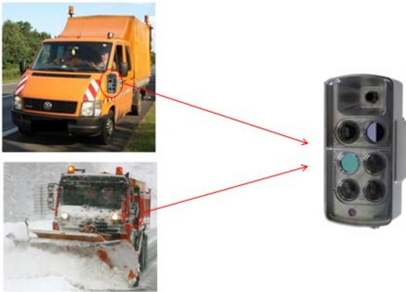
Slika 6.2. Mobilna meteorološka stanica [10]
