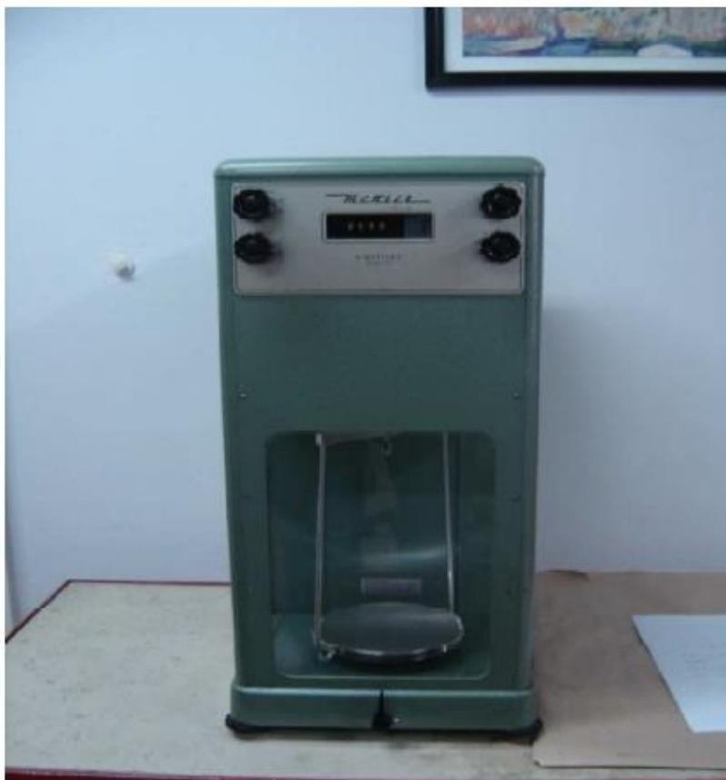
Slika 22. Vaga METLER B5C 1000 za precizno mjerenje gubitka mase pri tribološkim ispitivanjima.
