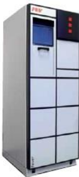
Slika 8.2. FEV EmissionRate FEVER mjerna stanica[15]
