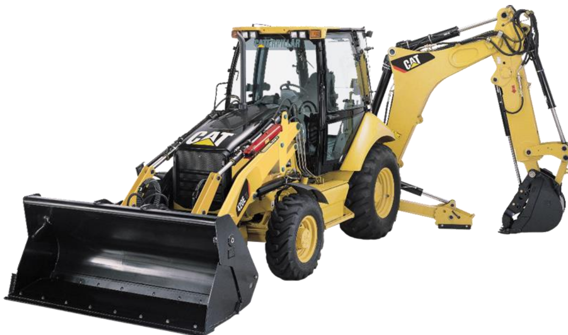
Slika 4.2. Caterpillar 434E rovokopač pogonjen Dieselovim motorom snage 68,5 kW [5]
