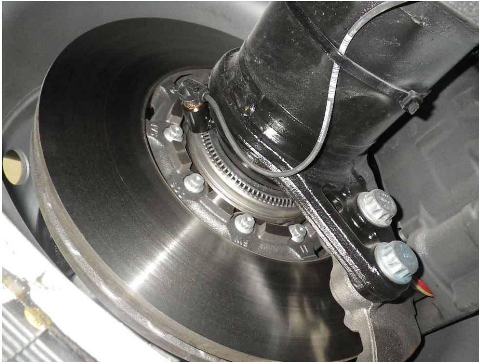
Slika 3.12 Senzor brzine vrtnje kotača
