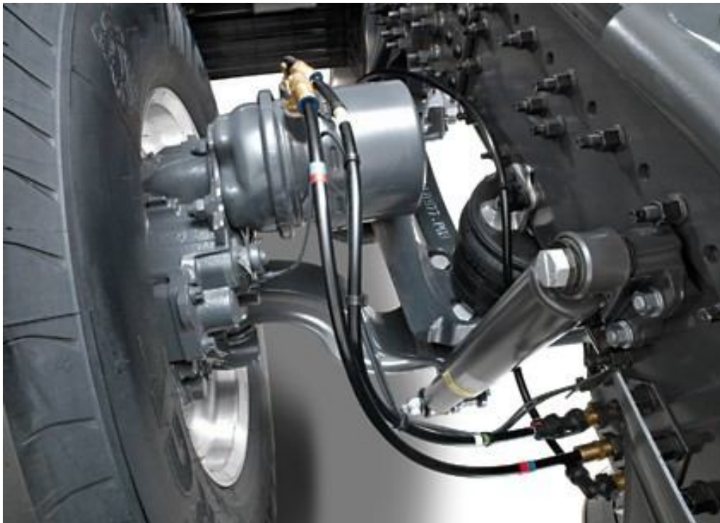
Slika 3.11 Tristop kočni cilindar
