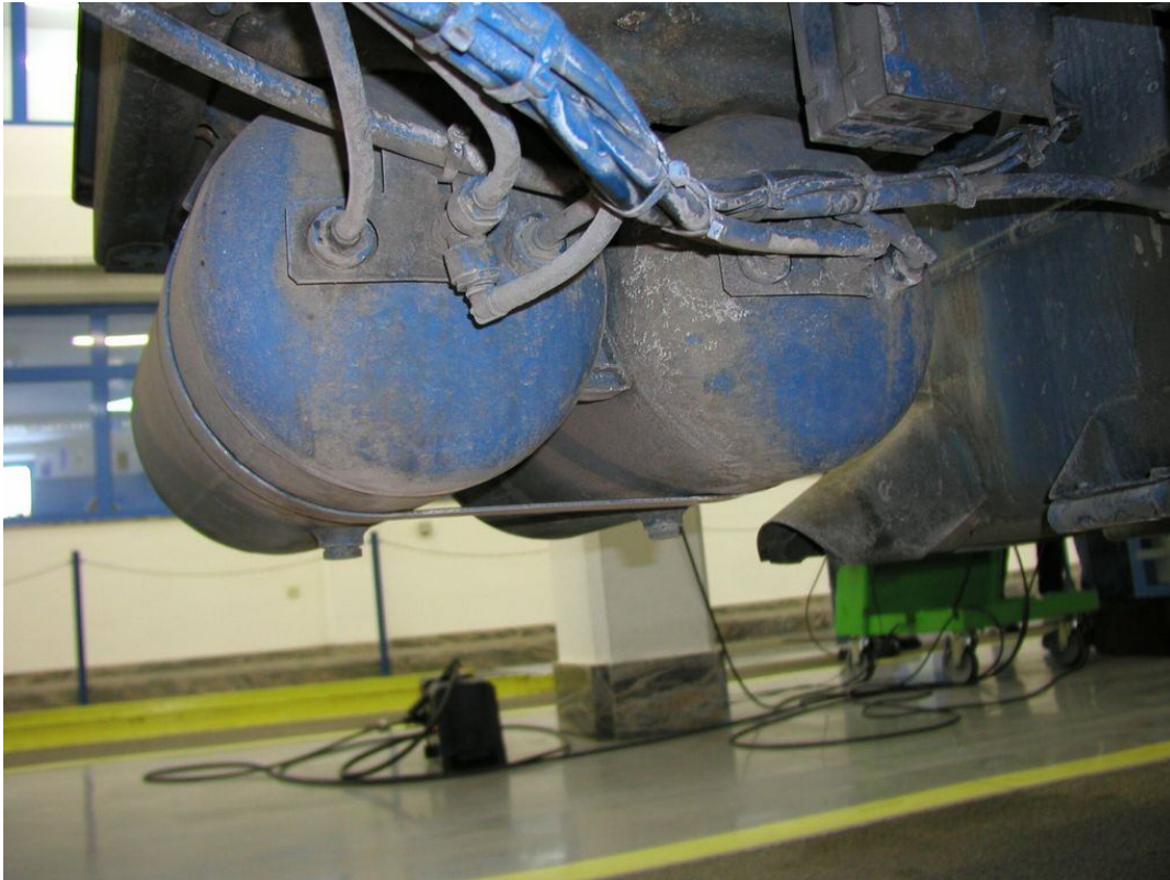
Slika 3.6 Spremnici zraka na vozilu
