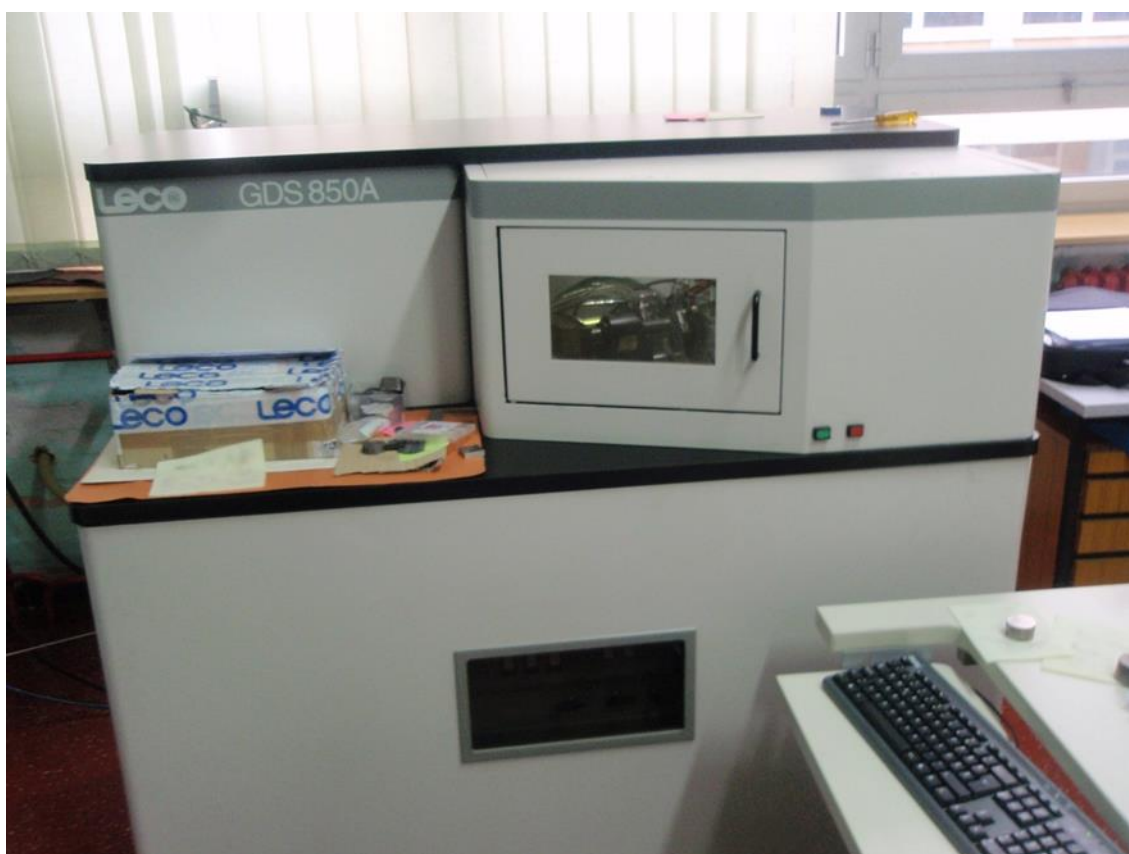
Slika 4. Instrument Leco GDS 850A.
