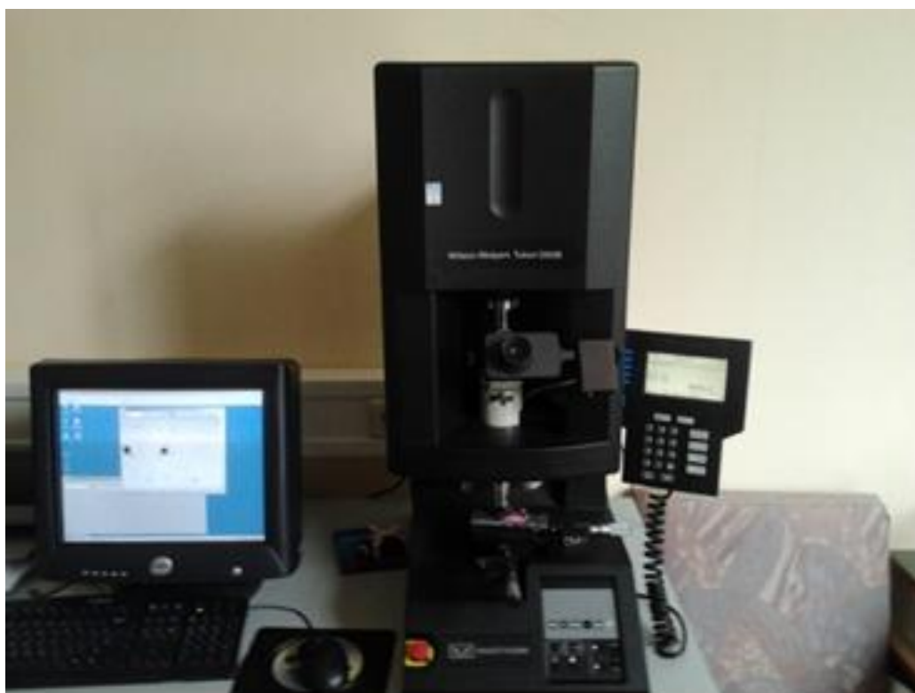
Slika 16. Mikrotvrdomjer WILSON-WOLPERT TUKON 2100 B proizvođača INSTRON.
