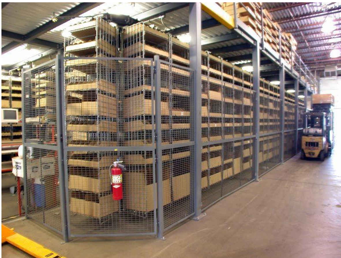
Slika 1. Horizontalni karusel zaštićen ogradom
