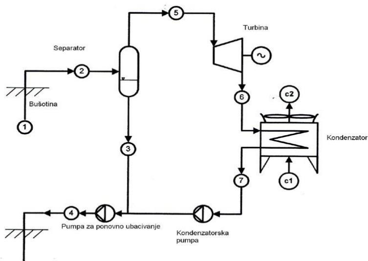
Slika 13. Shema procesa s jednostrukim isparavanjem [1]
