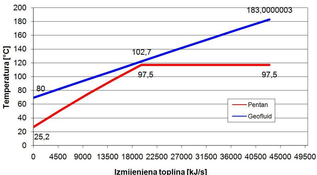
Slika 23. Ovisnost temperature struja o izmjenjenoj toplini u predgrijaču-isparivaču
