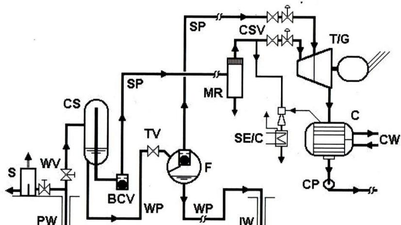
Slika 15. Toplinska shema ciklusa geotermalne elektrane s dvostrukim isparavanjem[1]
