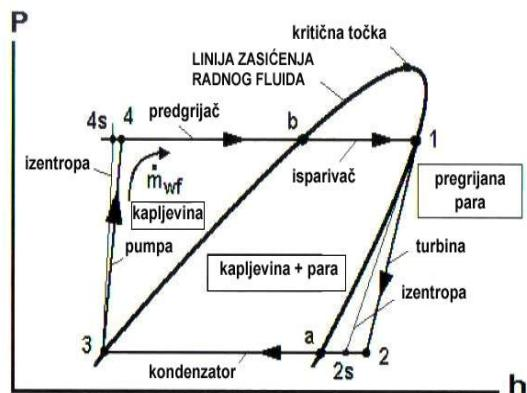
Slika 22. p-h dijagram geotermalne elektrane s binarnim ciklусом i lako hlapljivim pentanom [1]
