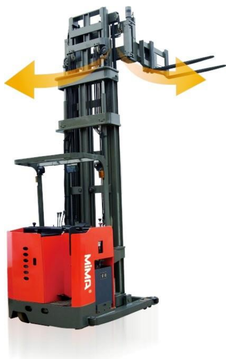
Slika 11. VNA viličar sa zakretnim vilicama [5]
