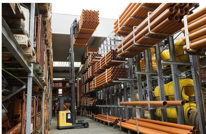
Slika 16. Korištenje četverosmjernog viličara za dugačke proizvode [7]
