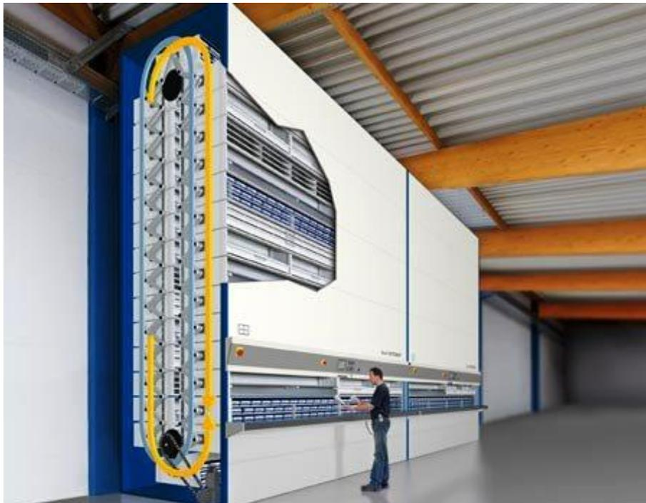
Slika 33. Vertikalni karusel [22]
