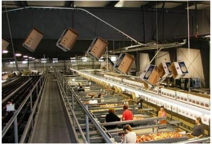
Slika 21. Transport praznih kutija ovjesnim konvejerom [13]
