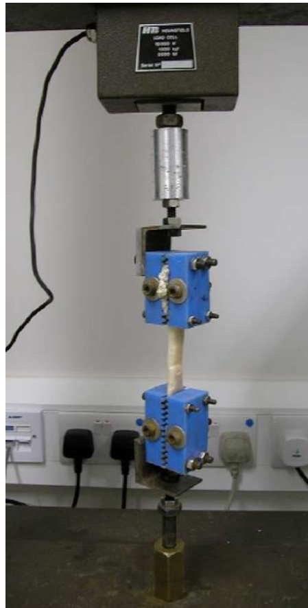
Slika 11. Statički vlačni test s nazubljenim čeljustima – model 1 [8]
