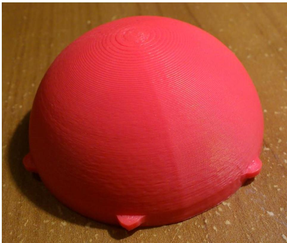
Slika 5.20. FDM model polimerne čašice implantata kuka
