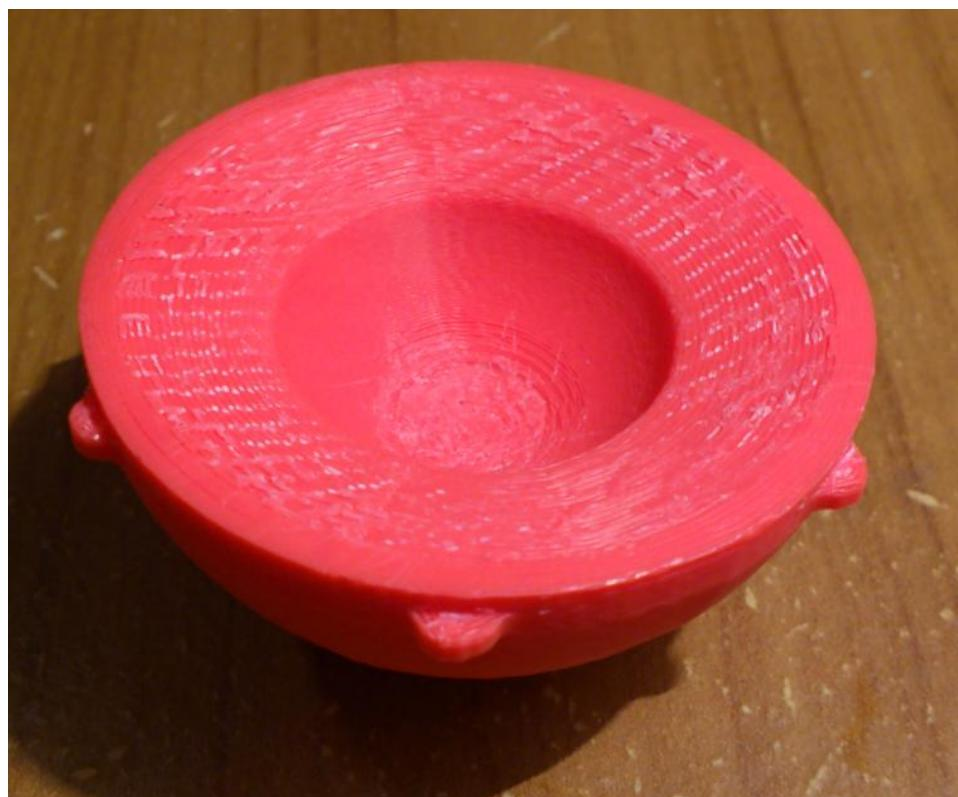
Slika 5.21. FDM model polimerne čašice implantata kuka
