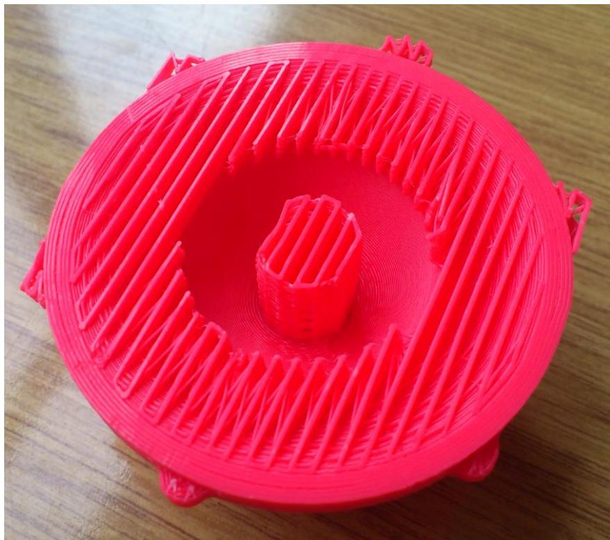
Slika 5.19. Središnji dio čašice s vidljivim potpornim dijelovima
