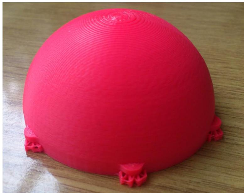
Slika 5.18. Proizvedeni model s potpornim dijelovima
