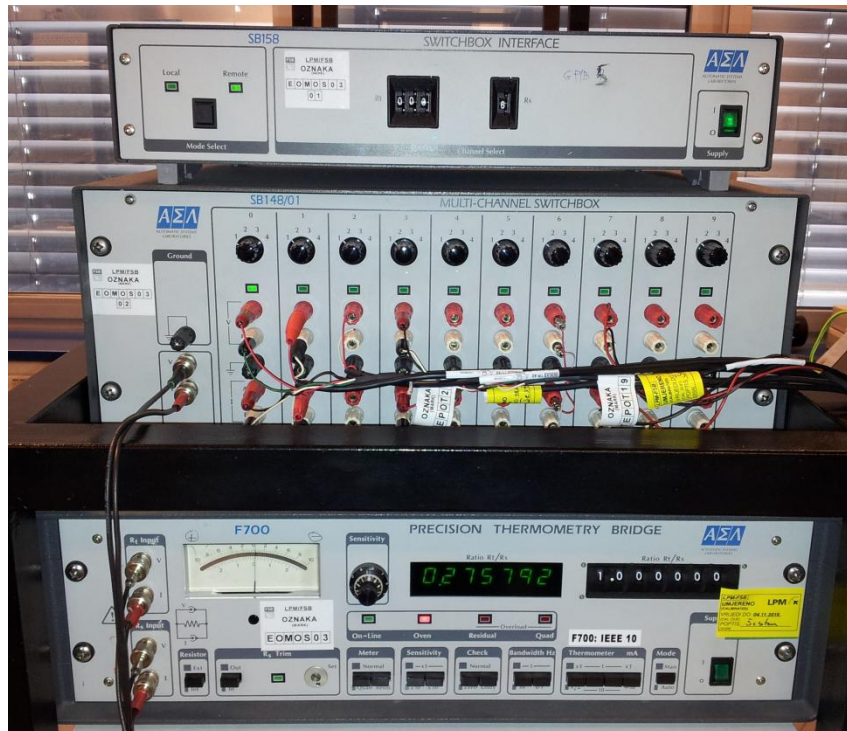
Slika 9. Termometrijski otpornički most ( spojene sve navedene komponente )
