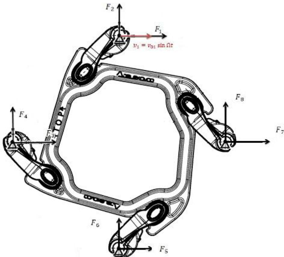
Slika 4.3 Određivanje mehaničke impedancije rastojnika – prigušivača tipa „diamond“ [12]
