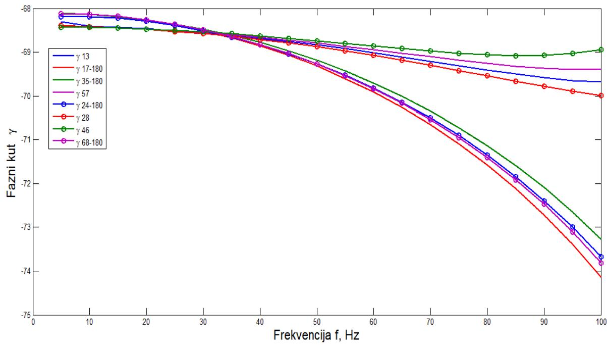
Slika 7.8 Ovisnost  $\gamma$  o frekvenciji
