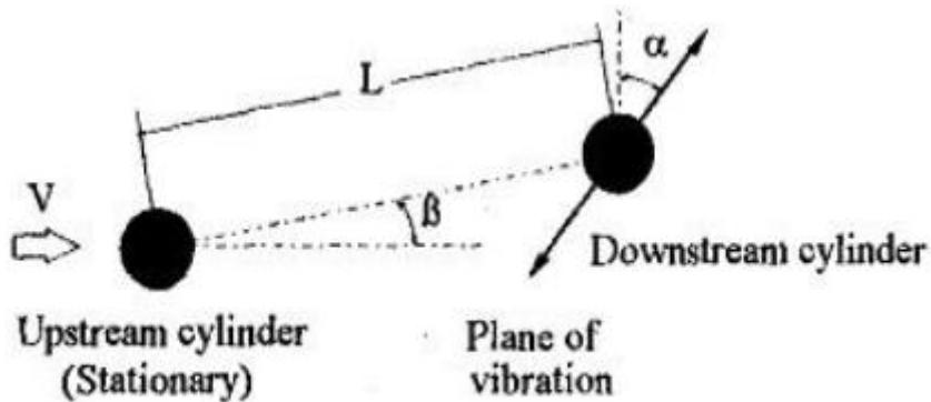
Slika 2.4 Primjer modela za ispitivanje snopa užadi [4]
