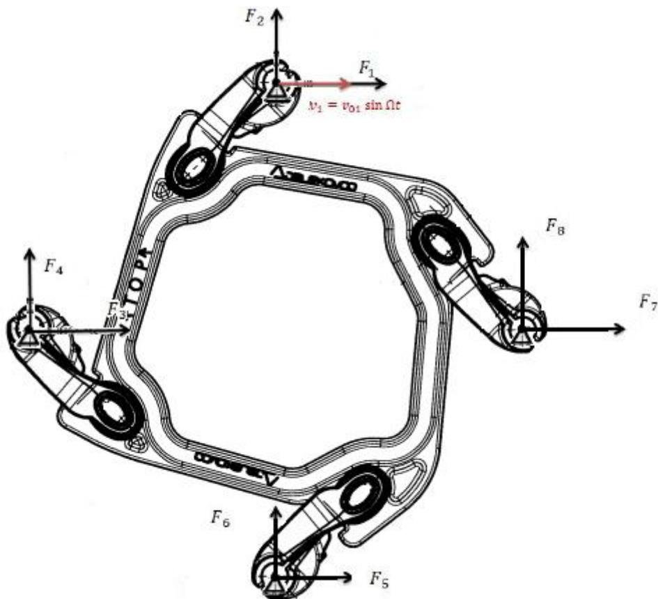
**Slika 7.1 Razmatrani rastojnik – prigušivač s prikazanom uzbudom i reaktivnim silama [12]**
