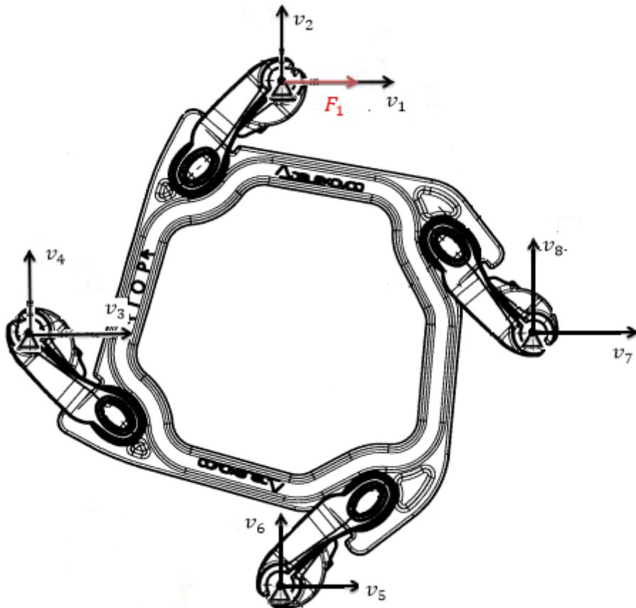
**Slika 4.2 Određivanje mehaničke mobilnosti rastojnika – prigušivača tipa „diamond“**
