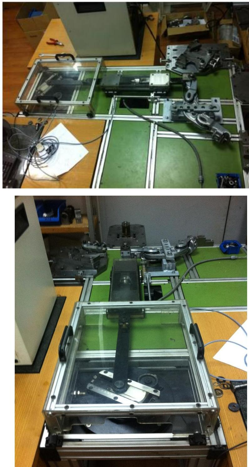
**Slika 5.4 Uredaj za ispitivanje konstantne krutosti i konstante prigušenja zgloba rastojnika – prigušivača [14]**
