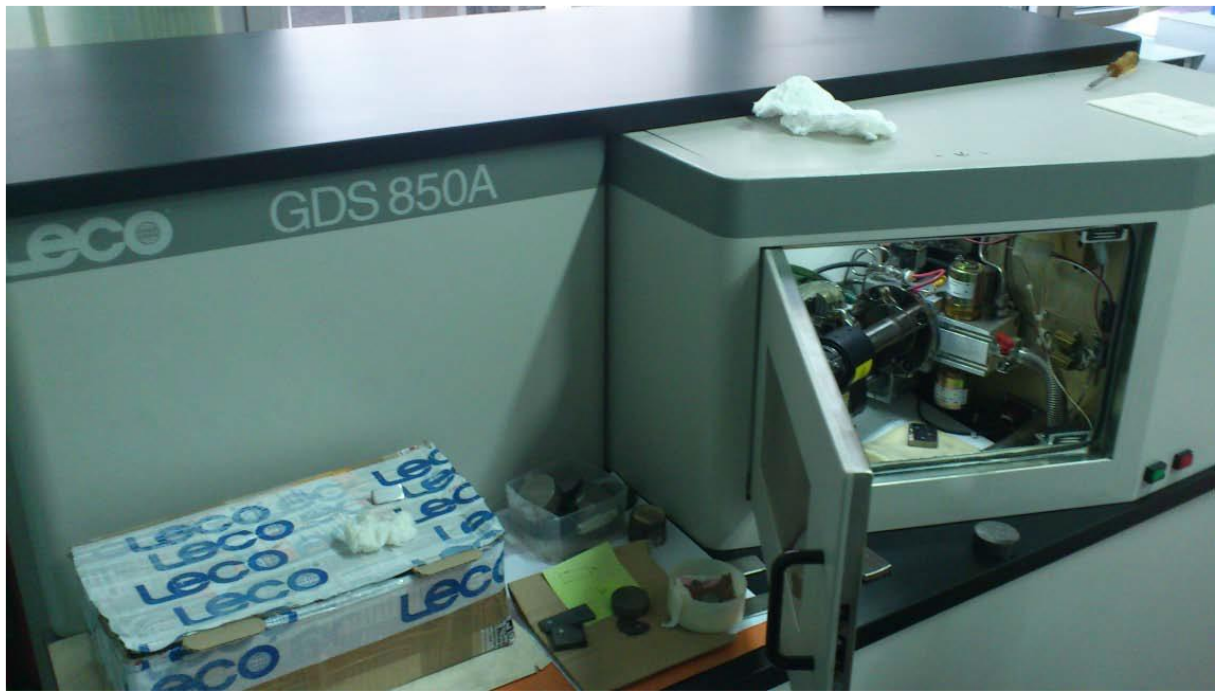
Slika 15. Uređaj LECO GDS 850A za optičku emisijsku spektrometriju (GDOS)
