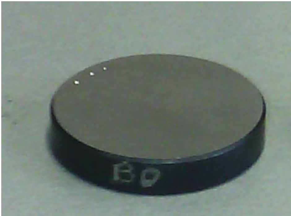
Slika 10. Uzorak čelika UTOP Mo1
