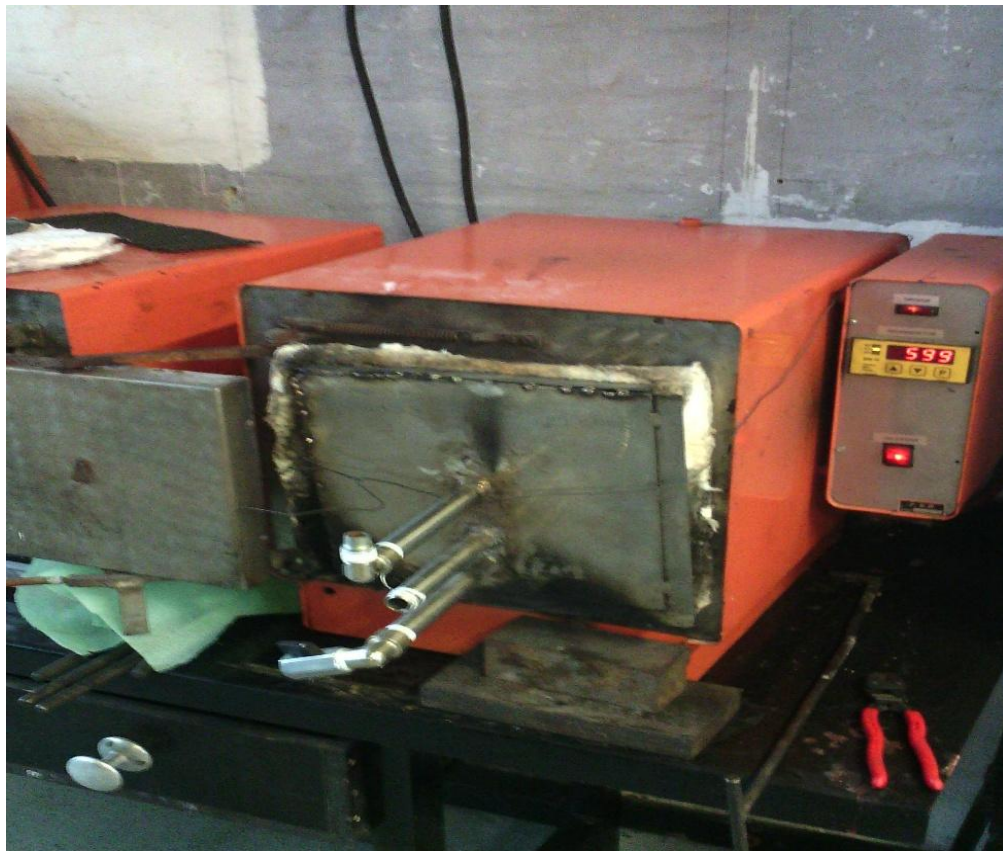
Slika 6. Peć za provođenje postupka aluminiziranja
