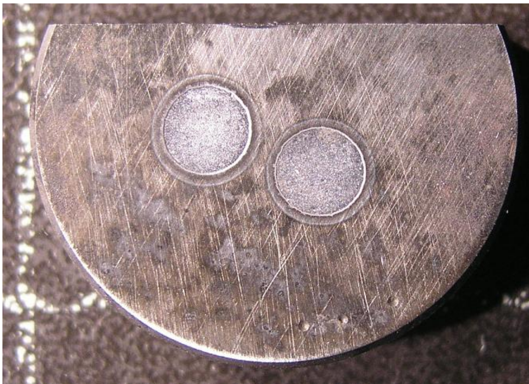
Slika 16. Izgled uzorka nakon provedene GDOS analize
