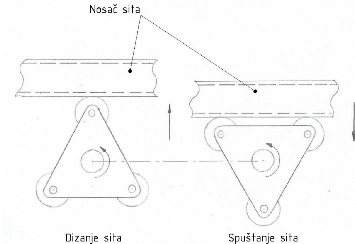
**Slika 23. Princip rada mehanizma vibriranja**
