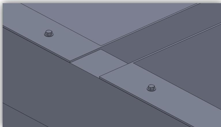
**Slika 59. Pričvršćivanje limenih rasipača samobušećim vijcima**
