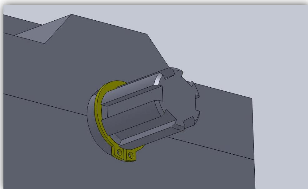
Slika 53. Uskočni prsten za aksijalno fiksiranje spojne čašice
