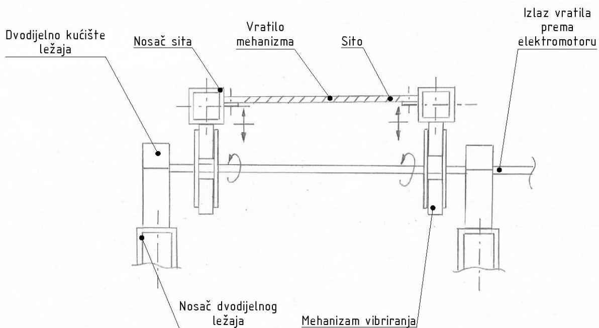
**Slika 22. Kontakt mehanizma i nosača sita (pogled iz nacrtta)**
