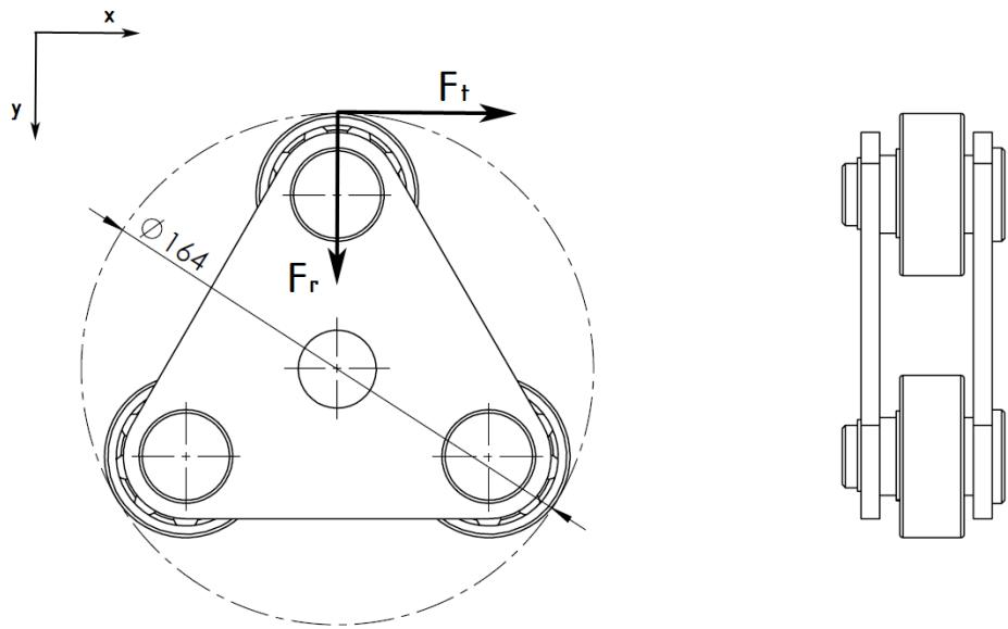
**Slika 30. Opterećenje mehanizma vibriranja**
