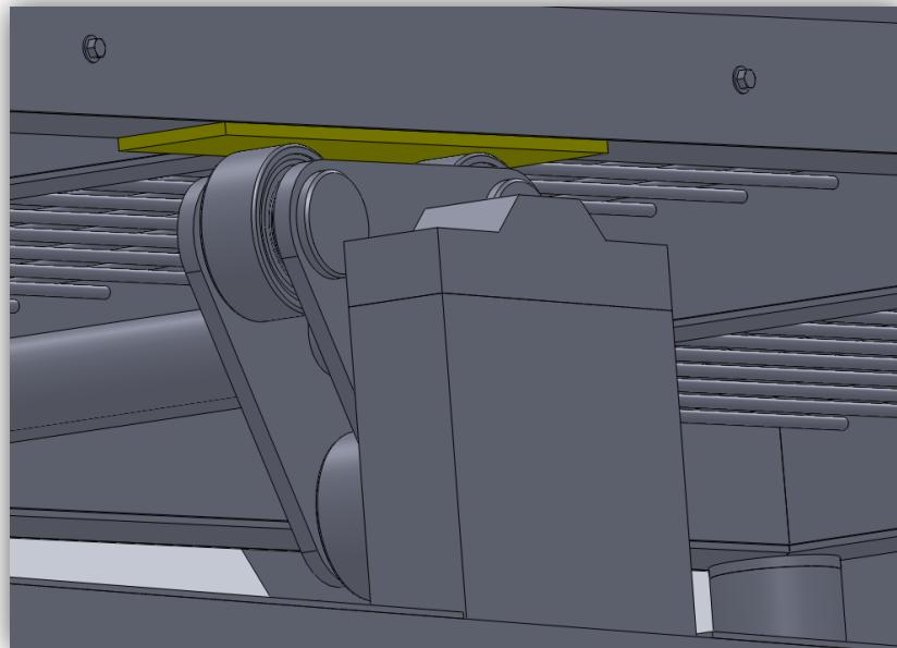
**Slika 50. Kontakt mehanizma vibriranja i tvrde gume nosača**
