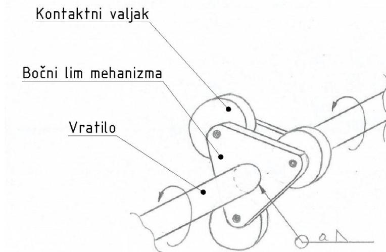
**Slika 21. Mehanizam vibriranja**
