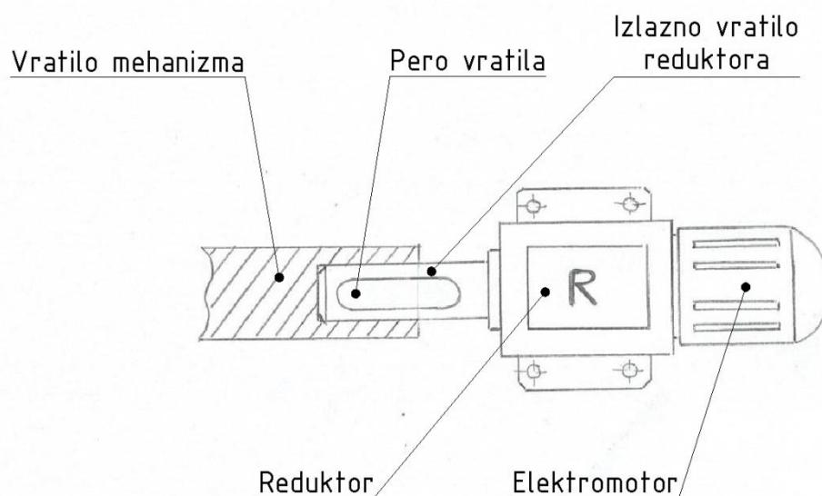
**Slika 24. Spoj izlaznog vratila reduktora i vratila mehanizma vibriranja**
