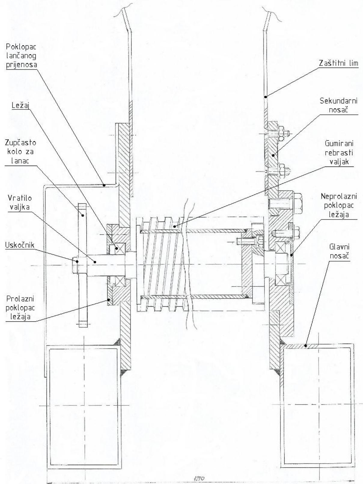
Slika 19. Prikaz položaja sortirnog valjka u presjeku
