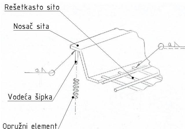
Slika 15. Veza rešetkastog sita i nosača sita
