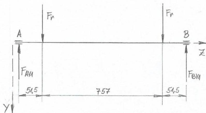
Slika 32. Prikaz sila na vratilo u vertikalnoj ravnini
