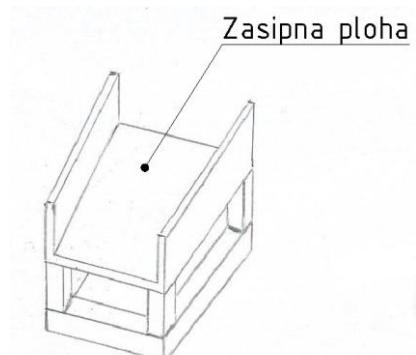
Slika 16. Izvedba zasipne plohe i njenih nosača
