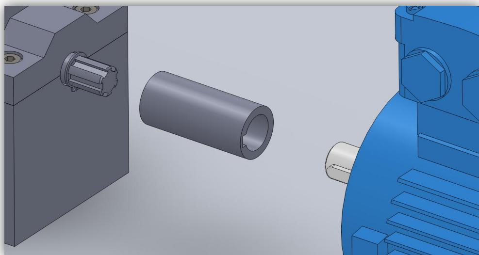
Slika 52. Izvedba spajanja dvaju vratila spojnom čašicom
