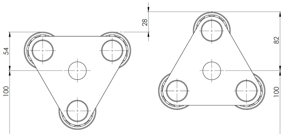
Slika 27. Hod opruge u zavisnosti o položaju mehanizma vibriranja
