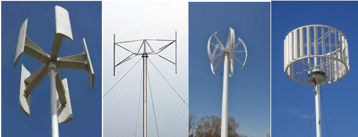
Slika 3 - Vjetroagregati s vertikalnom osi vrtnje [8]
