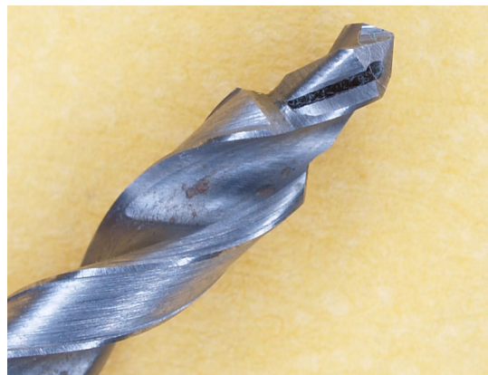
Slika 56. Oštrica dvostupnjevanog svrdla br.1 promjera 2,5/3,4 nakon 180 mjerenja
