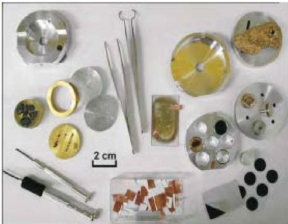
Slika 13. Pribor za pripremu i montiranje uzorka: aluminijski nosač uzorka, dvostruko ljepljive ugljikove trake, bakrena traka, pincete [13]
