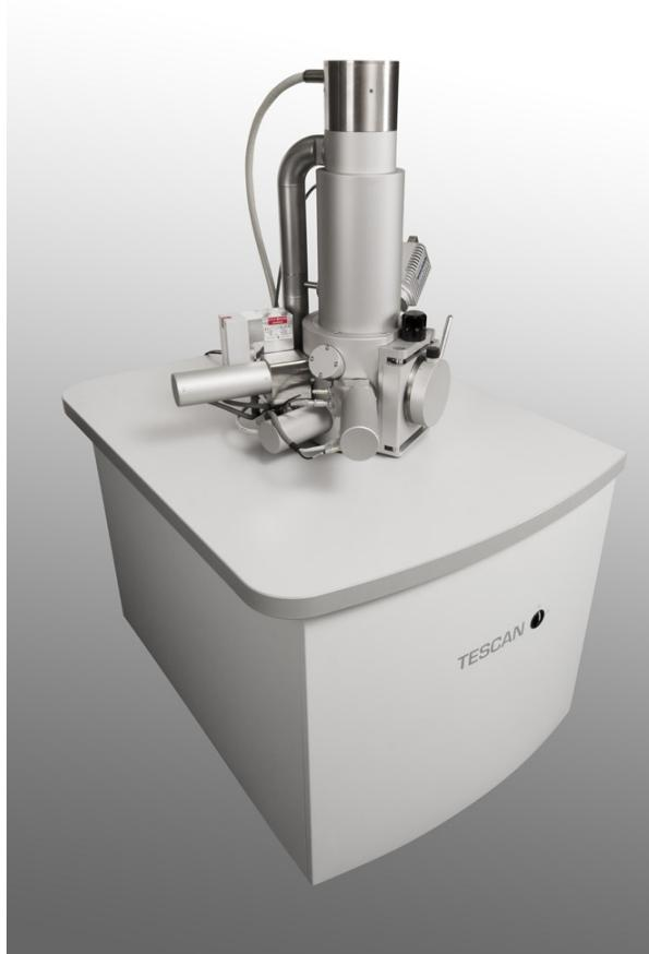
Slika 15. Skenirajući elektronski mikroskop Tescan Vega [18]
