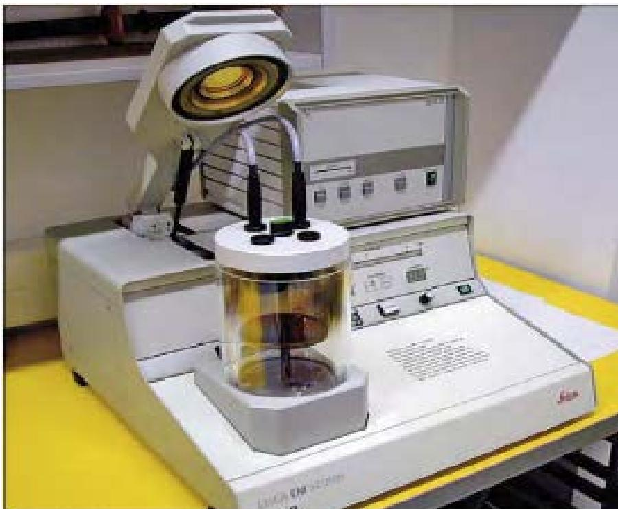
Slika 14. Uređaj za naparivanje uzorka [13]
