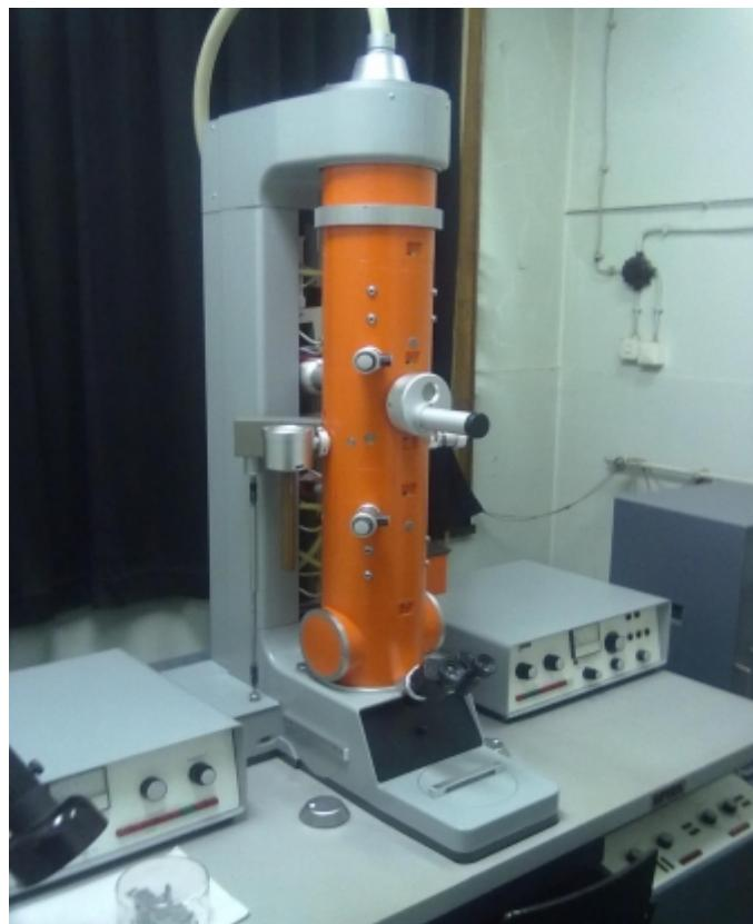
Slika 7. Transmisijski elektronski mikroskop [11]
