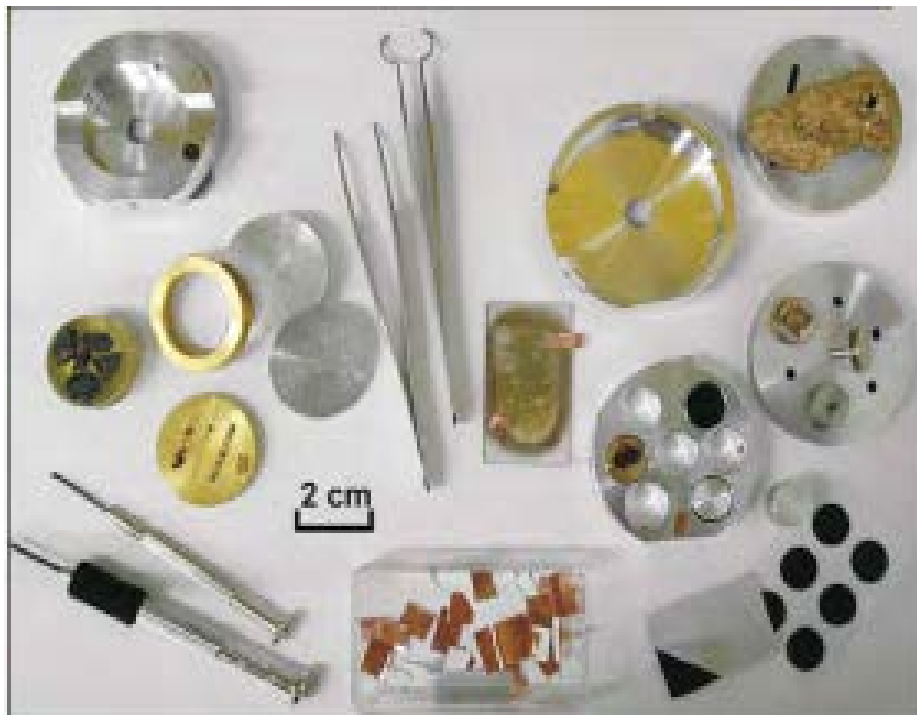
Slika 13. Pribor za pripremu i montiranje uzoraka: aluminijски nosači uzoraka, dvostruko ljepljive ugljikove trake, bakrena traka, pincete [13]
