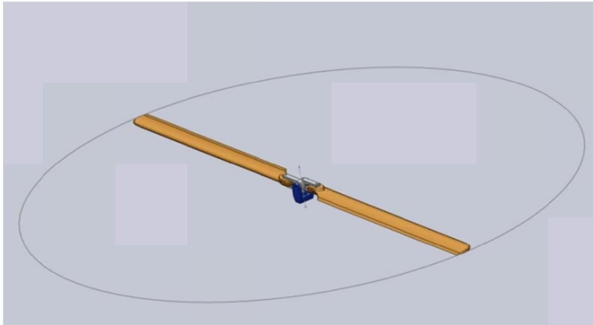
Slika 2: Rotor modela autogira, osi i disk rotora
