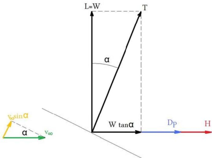
Slika 19: Dijagram sile i brzine u metodi otpora
