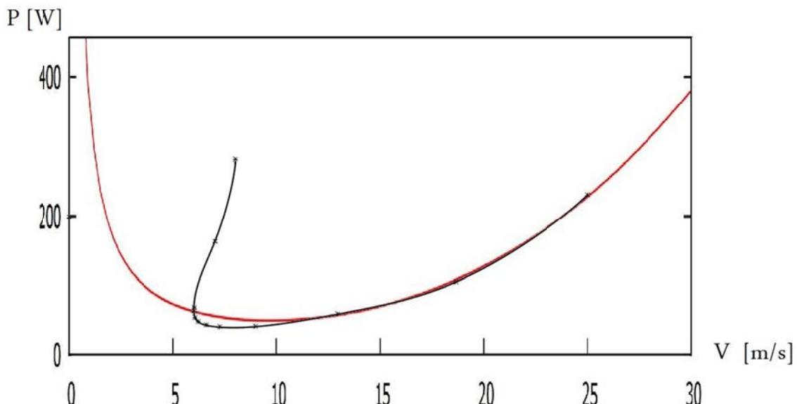
Slika 21: Dijagram s prikazom potrebne snage za horizontalni let po metodi otpora (crno) i Leishmanovoj metodi (crveno).
