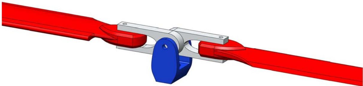
**Slika 10: Dijelovi rotora: glava (plavo), krakovi (sivo) i lopatice (crveno)**
