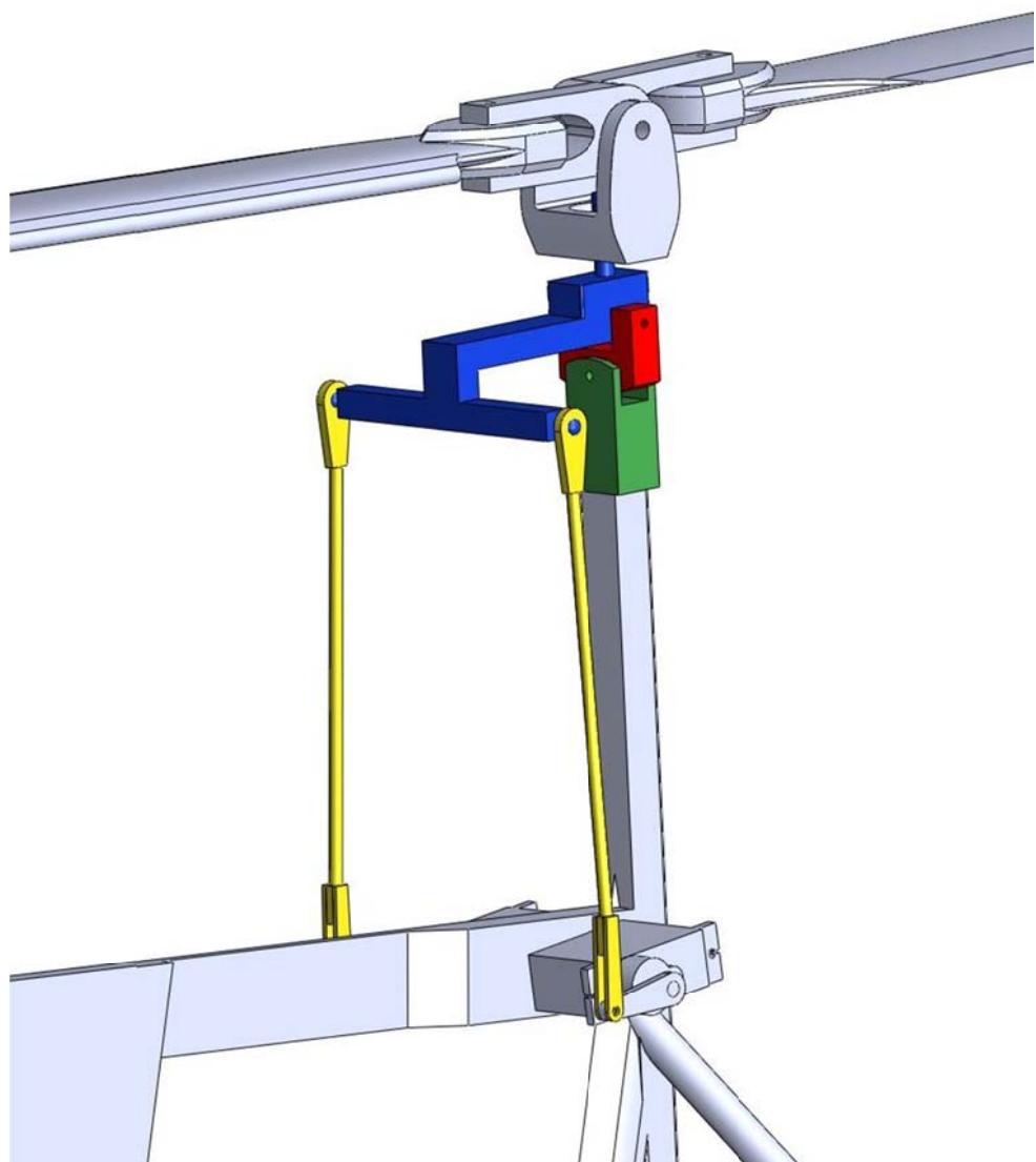
Slika 17: Upravljački mehanizam bespilotne letjelice autogira, fiksni dio (zeleno), drugi dio (crveno), treći dio (plavo) i spojne šipke za upravljanje (žuto)
