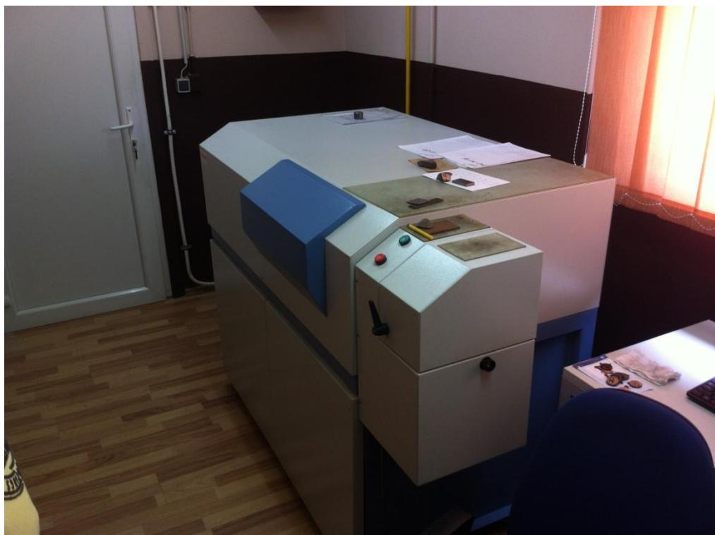
Slika 35. Uređaj za ispitivanje kemijskog sastava
