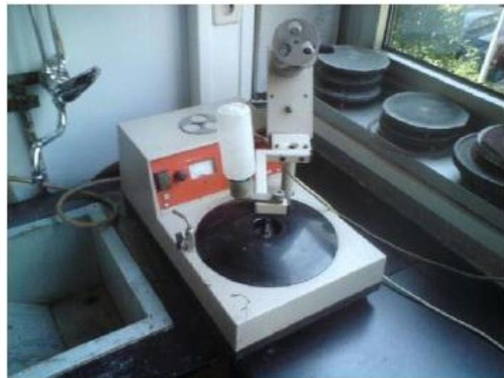
Slika 40. Uređaj za poliranje uzoraka
