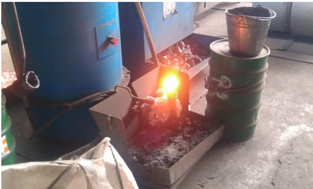
Slika 31. Toplinska analiza Quick – cup čašicom
