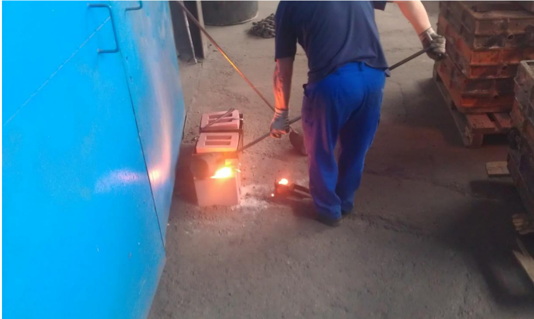
Slika 33. Lijevanje taljevine u kalupe
