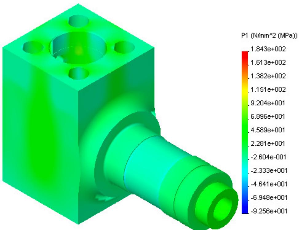
Slika 15. Glavna naprezanja kućišta visokotlačne pumpe
