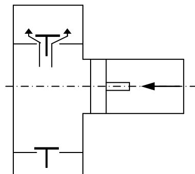
Slika 2. Shema rada klipne visokotlačne pumpe
