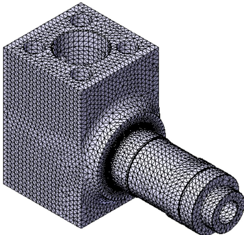
Slika 14. Kućište visokotlačne pumpe sa izrađenom mrežom
