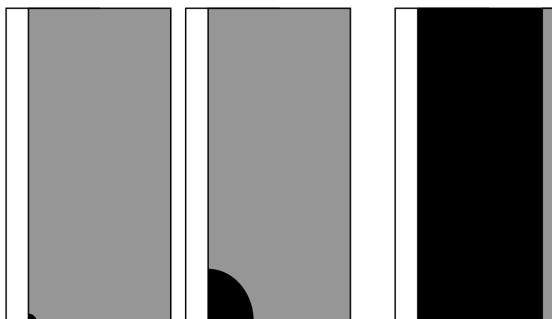
Slika 37. Izgled modela pukotine i širenje pukotine do loma [5]
