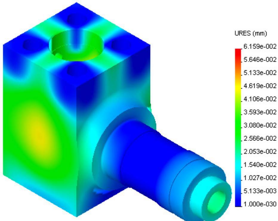
Slika 21. Kućište pumpe s prikazom rezultirajućih pomaka u čvorovima
