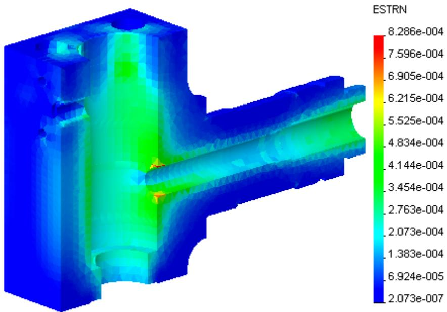
Slika 20. Presjek kućišta s prikazom ekvivalentnih deformacija
