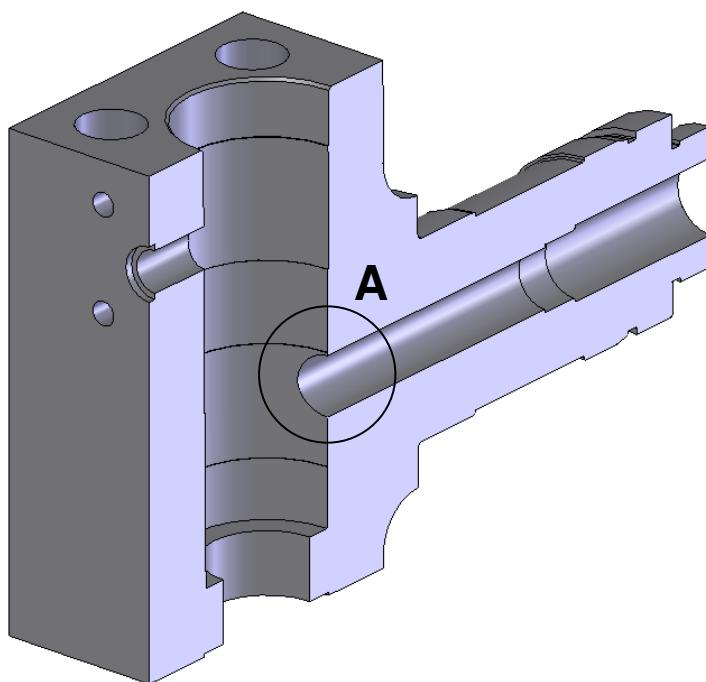
Slika 23. Presjek kućišta s prikazom kritičnim dijelom provrta
