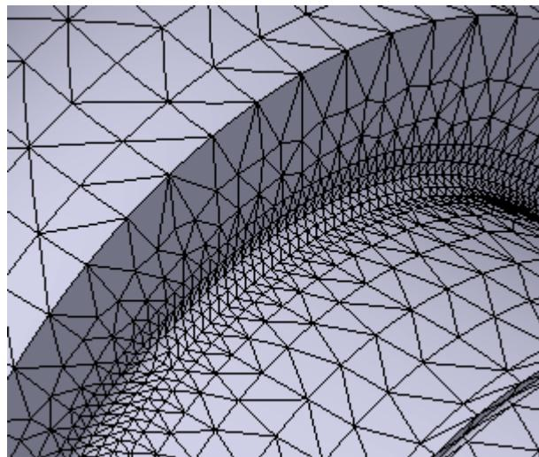
Slika 12. Kontrola mreže na vanjskom radijusu kućišta
