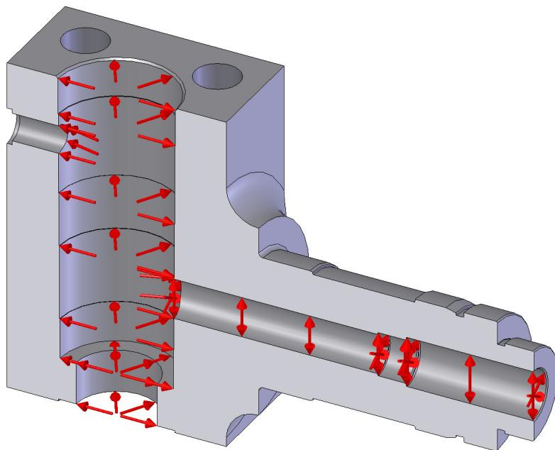
Slika 10. Presjek modela sa postavljenim proračunskim opterećenjem
