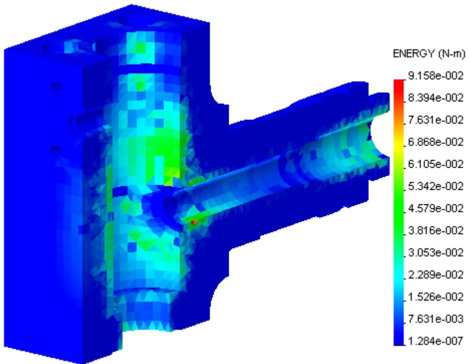
Slika 19. Presjek kućišta s prikazom ukupne energije deformacija
