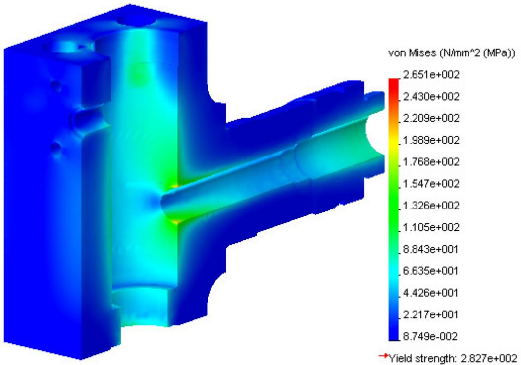
Slika 18. Presjek kućišta sa prikazanim von Mises naprezanjima
