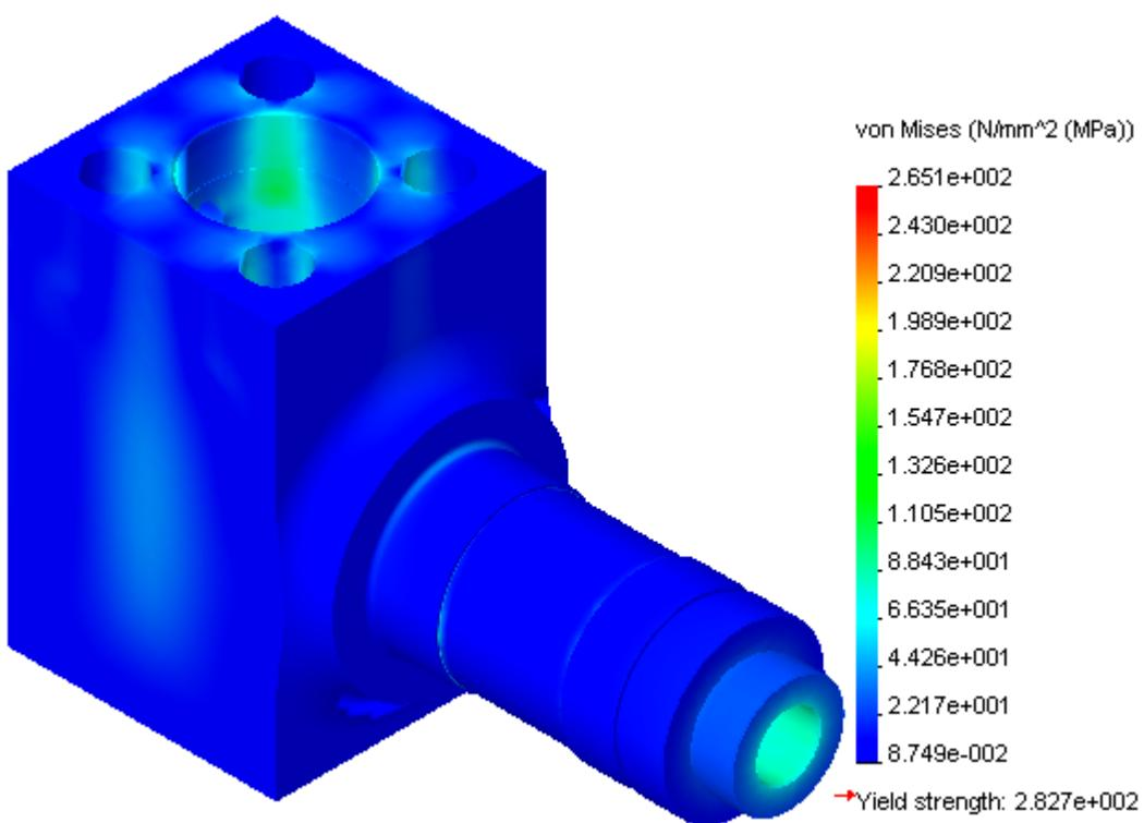
Slika 17. Von Mises naprezanja kućišta visokotlačne pumpe
