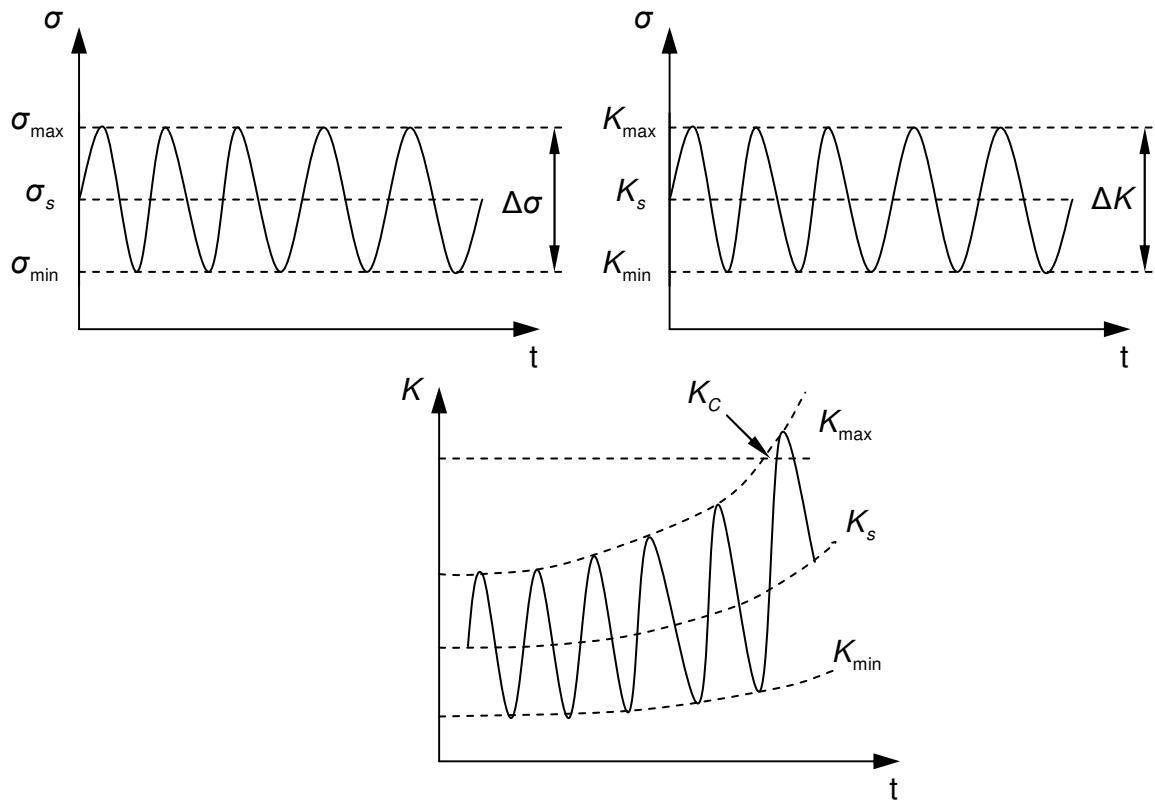
Slika 29. Promjena naprezanja i koeficijenata intenzivnosti naprezanja [3]
