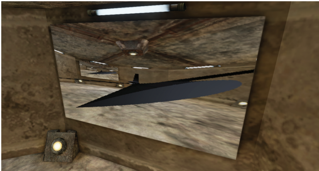
Slika 42 – Prikaz profila vrha kraka pomoću kamere koja se rotira s krakom. Pokretna slika se prikazuje na teksturi geometrijskog objekta pomoću tehnike koja se koristi za efekt zrcala, kao primjerice za simulaciju vodene površine.
