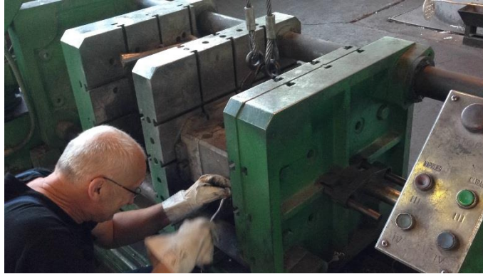
Slika 24. Demontaža postojeće kokile
