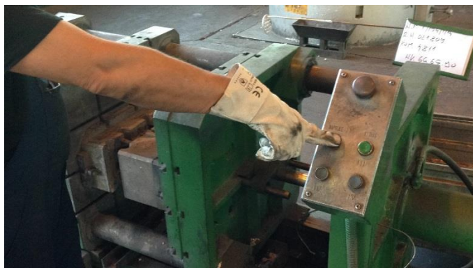
Slika 30. Probni rad nove kokile (provjeravanje centriranosti)
