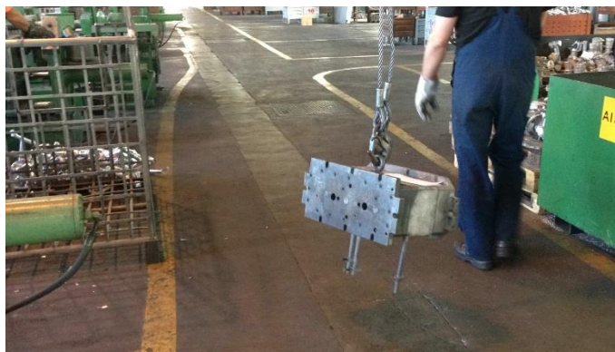
Slika 26. Transport nove kokile mostnom dizalicom
