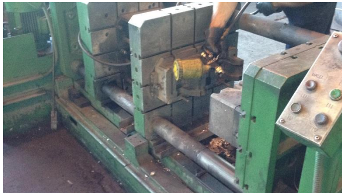
Slika 36. Špricanje kokile tekućinom
