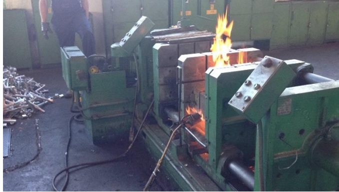
Slika 35. Zagrijavanje alata (kokile)
