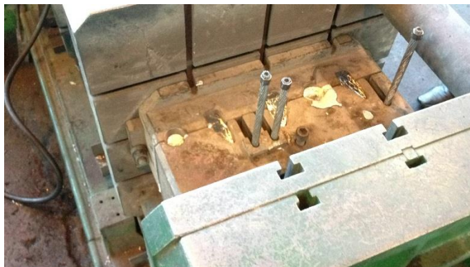
Slika 37. Lijevanje hvataljke sa užetom u kokili
