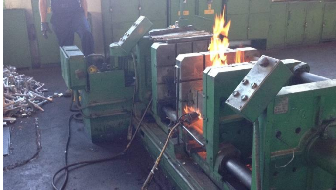
Slika 35. Zagrijavanje alata (kokile)
