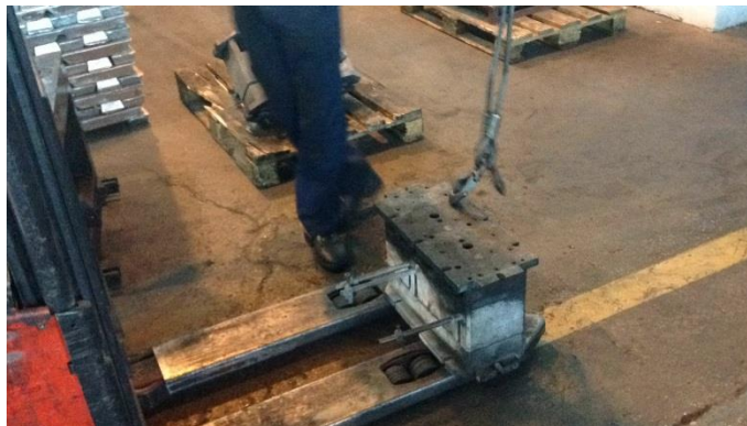
Slika 25. Pretovar kokile sa viličara na mostnu dizalicu
