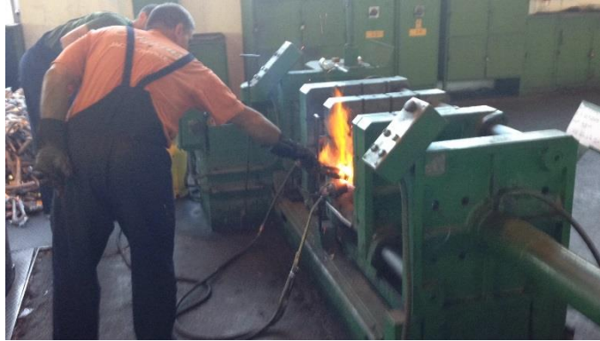
Slika 32. Početak zagrijavanja alata
