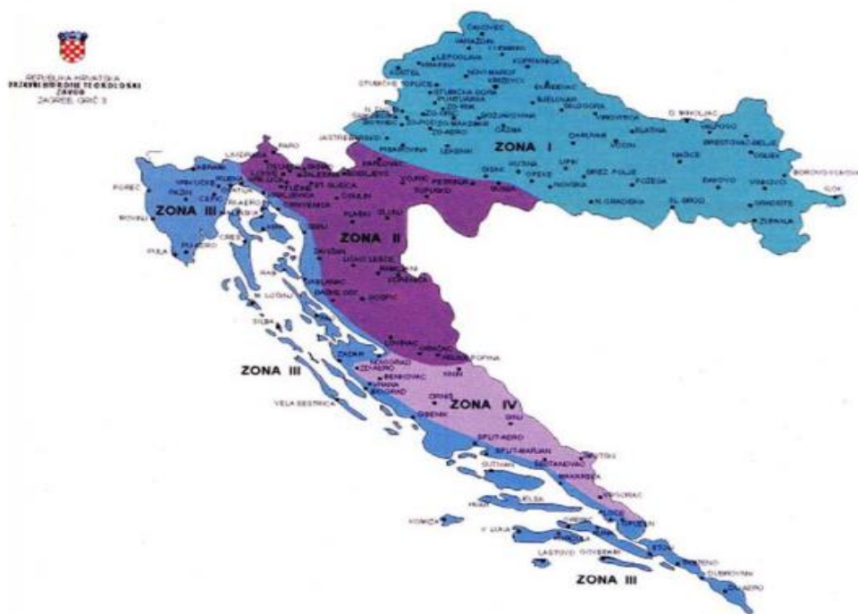
Slika 18. Karta karakterističnog opterećenja snijegom
