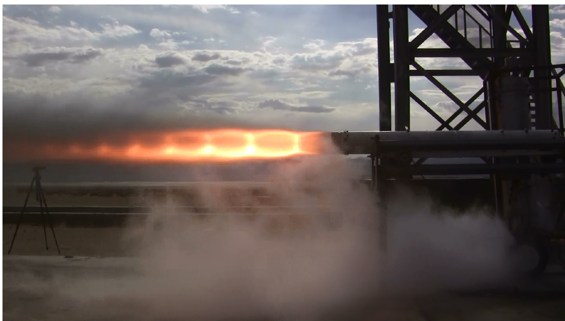
Slika 4.6: Oblik "dijamanata" na izlazu iz mlaznog motora [53].
