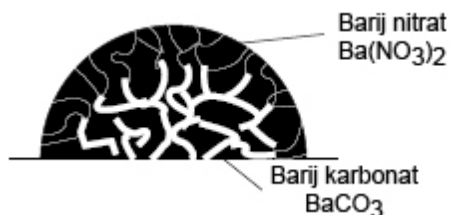
Slika 5. Prikaz čestice barija s porama u kojima se odvija pohrana dušikovih oksida
