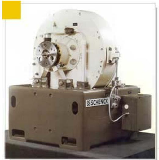
*Slika 2.5. Suvremena električna kočnica „Schenck Eddy Current Dynamometer“*
