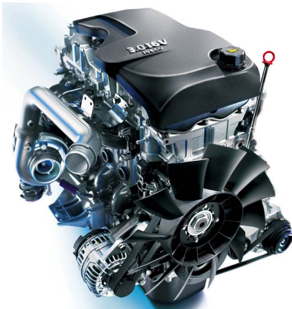
Slika 6. Izgled i karakteristike diesel motora F1C E0481H 130 kW [5]
