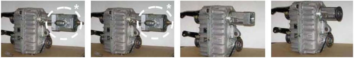
Slika 9. Različite varijante dodavanja epicikličnih reduktora ili radnih strojeva [11]
