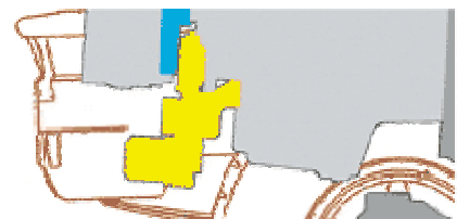
Slika 4. Priklučak za prijenos snaga na pomoćne uređaje s motora [5]
