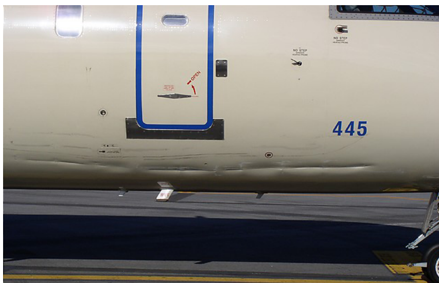
Slika 1.2 Oštećenje konstrukcije rudom za vuču [3]
