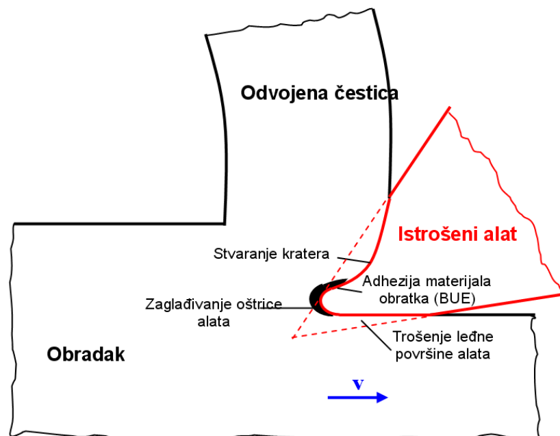
Slika 2.9. Trošenje alata [4]
