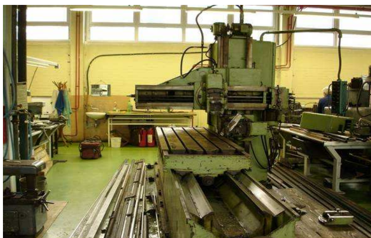
Slika 4.2. Blanjalica u postojećem stanju i prije rekonstrukcije
