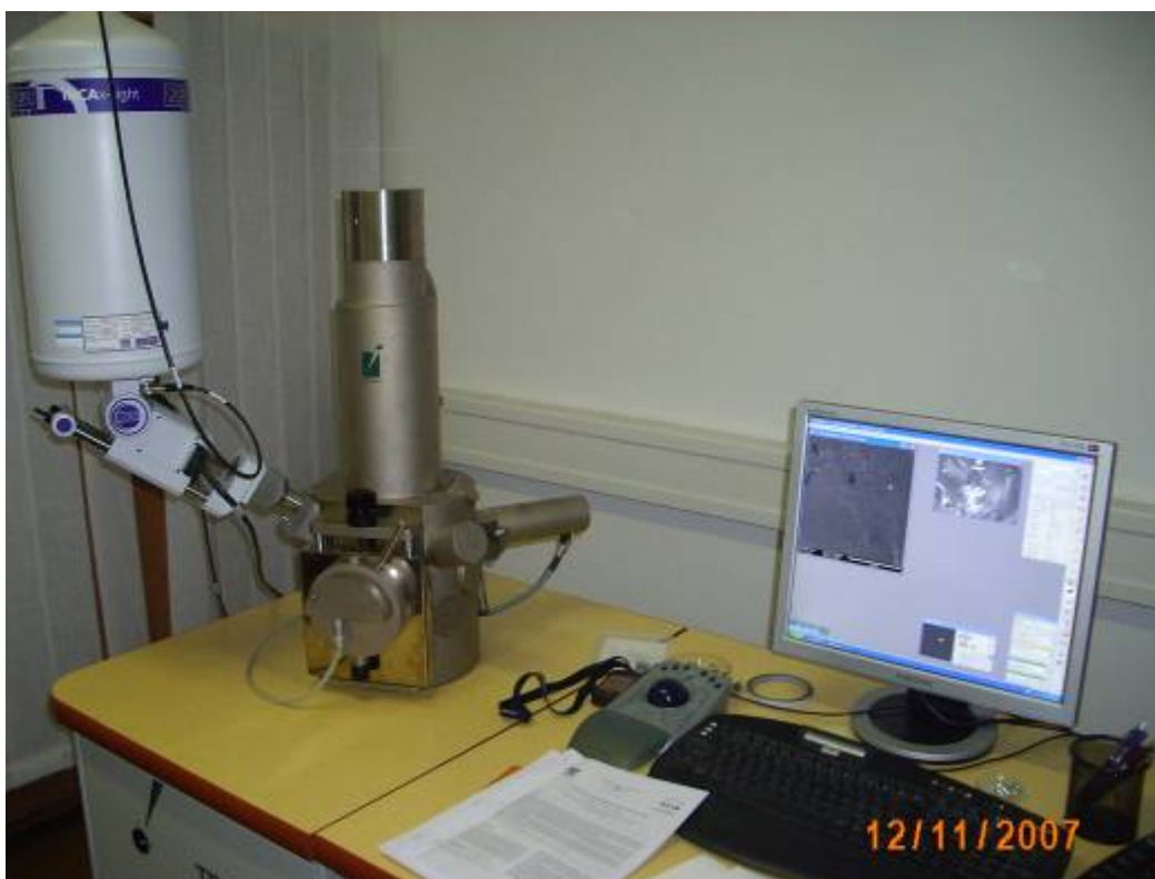
Slika 43 – Skening elektronski mikroskop Oxford Tescan
