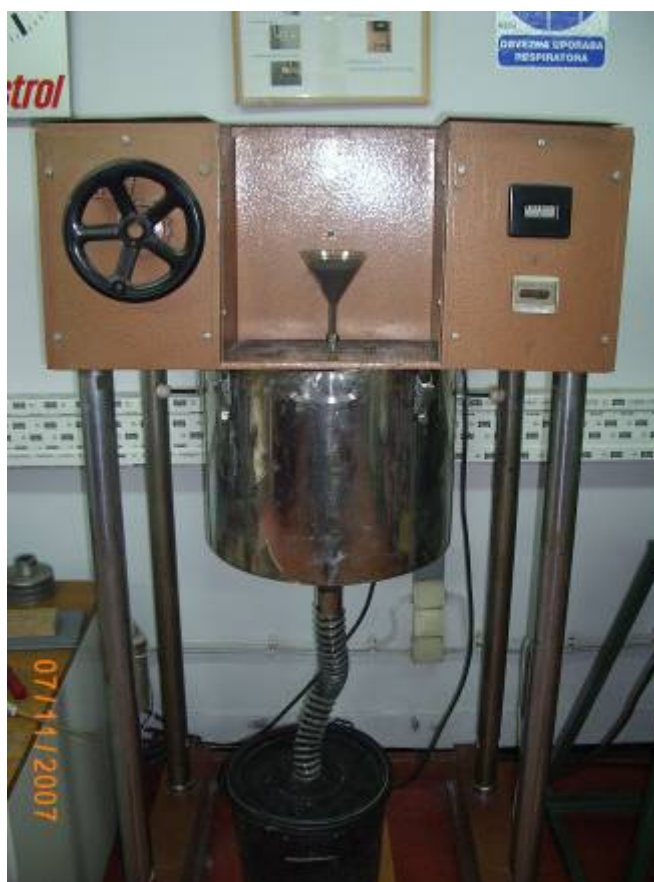
Slika 35 – Uređaj za ispitivanje otpornosti na eroziju
