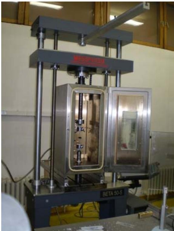
Slika 6.5. Komora i kidalica spremne za ispitivanje
