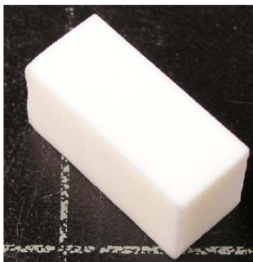
Slika 27. Sinterirani uzorak za ispitivanje kemijske postojanosti
