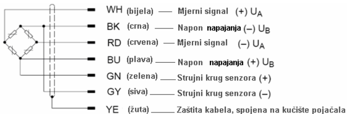
Slika 18. Konektori i spojna shema [13]
