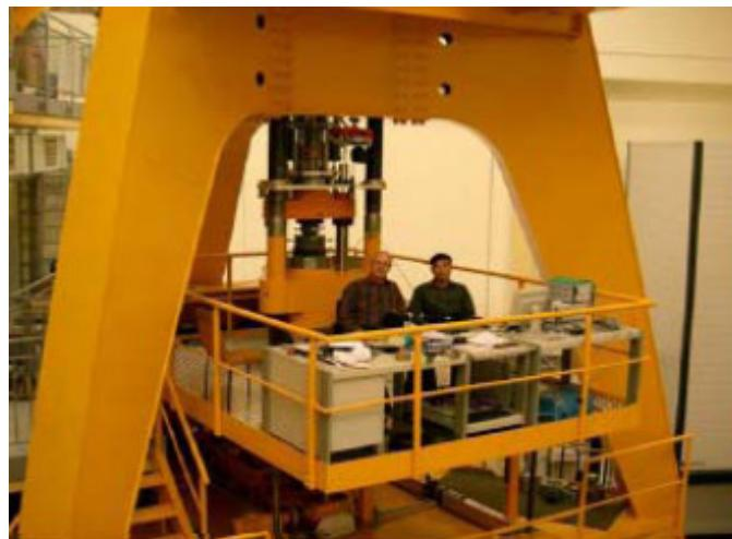
Slika 5. Primjer hidraulične kidalice nazivne sile 2 MN
