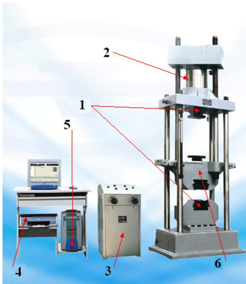
Slika 4. Prikaz hidraulične (univerzalne) kidalice [10]
