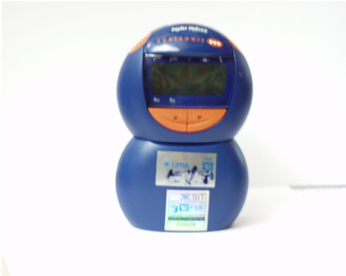
Slika 32. Instrument za mjerjenje hrapavosti
