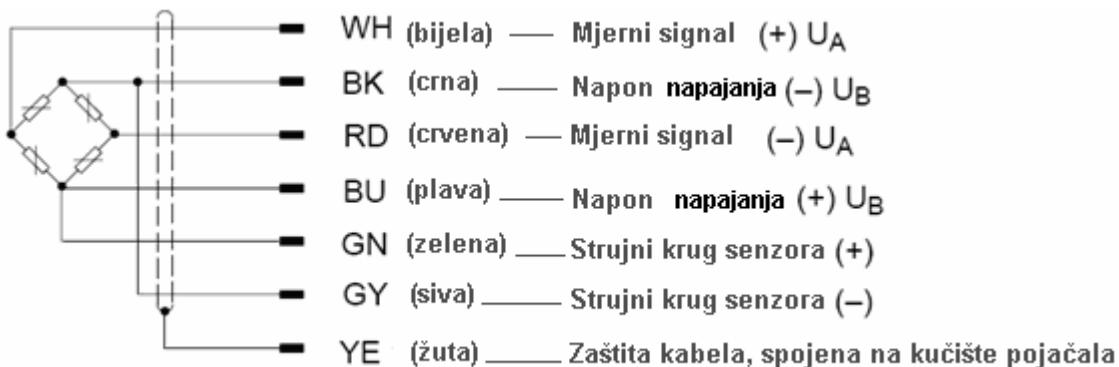
Slika 18. Konektori i spojna shema [13]
