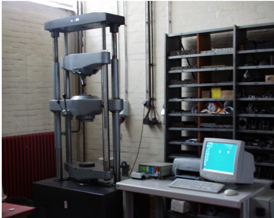
Slika 30. Umjeravana kidalica sa upravljačkim uređajem i PC-om
