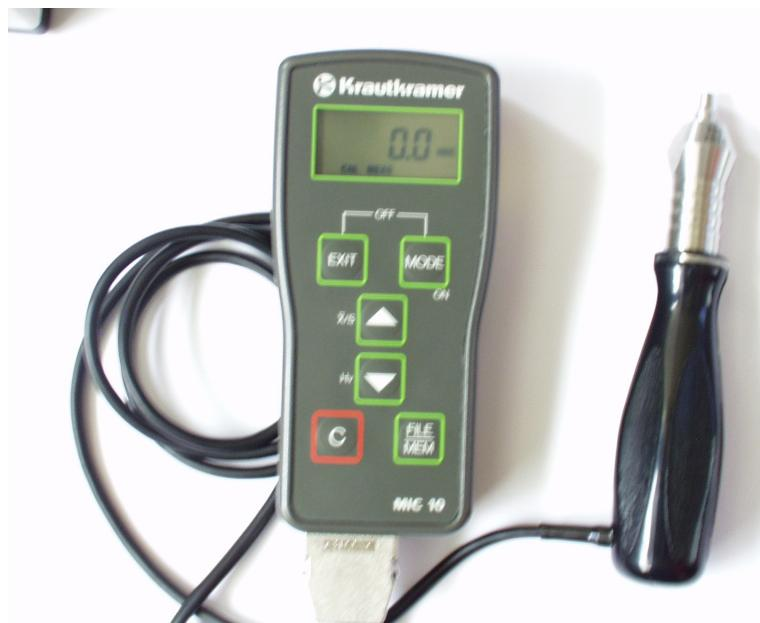
Slika 33. Prenosni tvrdomjer
