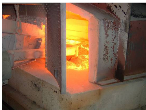
Slika 8: Ulaz smjese za taljenje u peć
