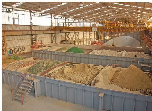
Slika 33: Natkriveno skladište kvarcnog pijeska i sode
