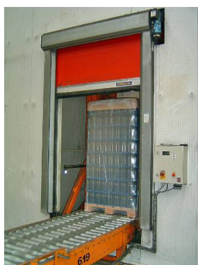
Slika 28: Izlazak palete iz lifta u skladištu
