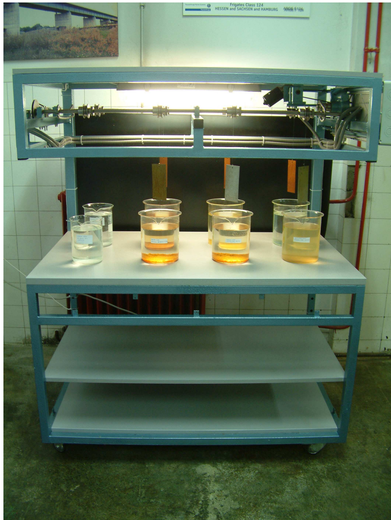
Slika 66. Naprava za ispitivanje uranjanjem prema normi ASTM G44 u Laboratoriju za zaštitu materijala Fakulteta Strojарstva i Brodogradnje Sveučilišta u Zagrebu 2008. godine
