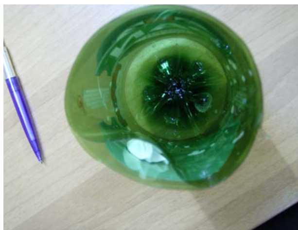
Slika 6.14. Višeslojna PET boca PAN piva
