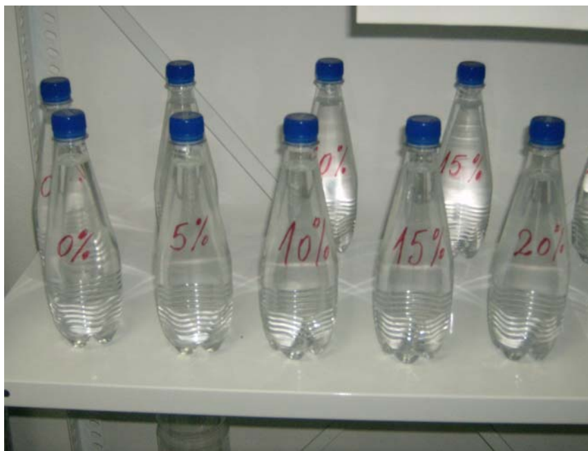
Slika 6.12. Prikaz PET boca s različitim postotkom reciklata u mješavini
