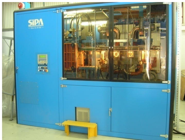
Slika 6.7. Puhalice SF 2/1 talijanske tvrtke SIPA
