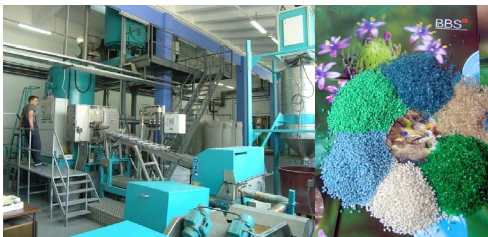
Slika 6.5. Linija za regranuliranje
