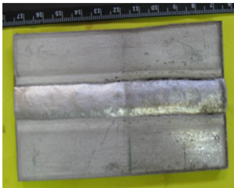
Slika 8.21.. Zavar sučeljenog spoja dobiven FCAW-G postupkom uz PPŽ kod uzorka G i razmak u korijenu od 1 mm manje je zahvaćen jamičastom korozijom od predhodna dva primjera. Osnovni metal je ploča manje plemenitog čelika (čelik 304; dodatni metal je čelik 316), dok je vidljiv razvoj rupičaste korozije uz liniju spoja metala zavora i ZUT-a. Mogući uzrok je samo naljepljivanje zavora, bez provara u korijenu.
