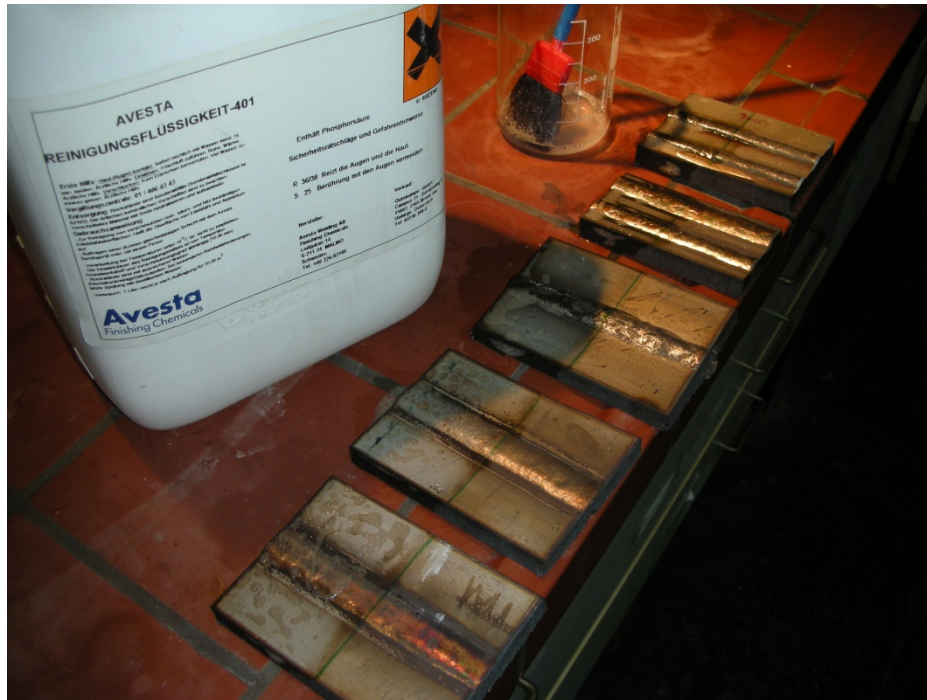
Slika 8.9. Prikaz odmašćenih, vodom ispranih i osušenih uzoraka koji će se bajcati. Crta okomito na zavar/navar dijeli uzorke na lijevi i desni dio, odnosno na očišćeni i neočišćeni dio. Do uzoraka se nalazi otopina za bajcanje u bijeloj plastičnoj posudi.
