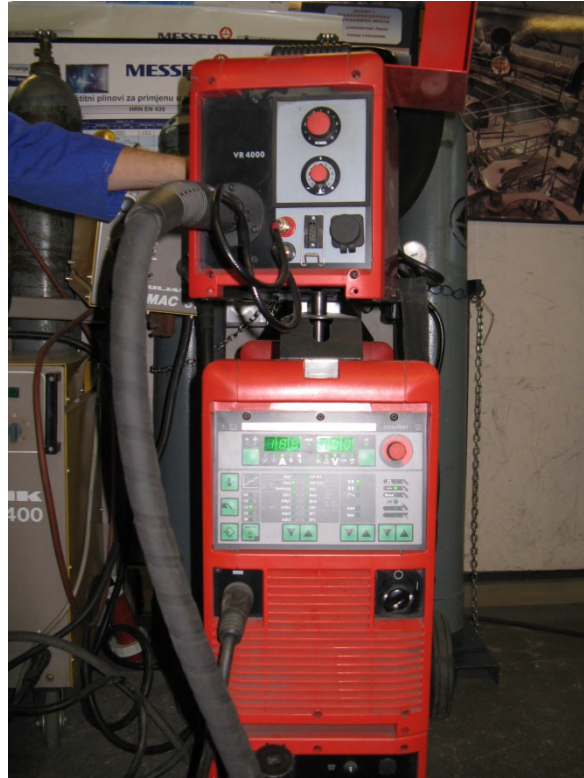
Slika 7.2. Izvora struje za zavarivanje MIG/MAG/FCAW postupkom sa dodavačem žice Fronius Trans Puls Synergic 3200.
