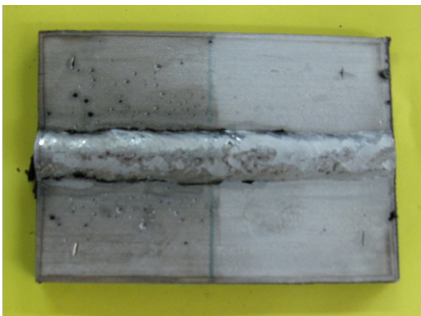
Slika 8.24. Najzorniji prikaz jamičaste korozije dobiven je na I uzorku. Linija spoja metala zavara i ZUT-a je najviše zahvaćena.
