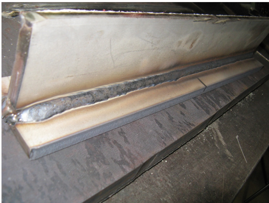
Slika 7.11. T spoj kutnog zavora čelika 316Ti (W.Nr. 1.4671) zavaren MIG postupkom uz punu žicu.
