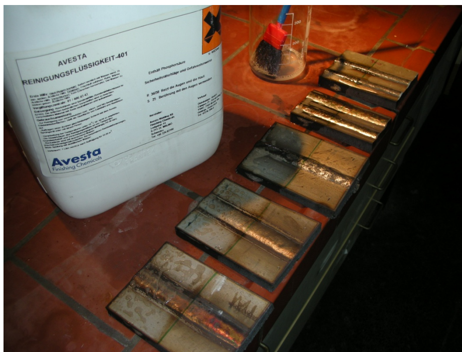
Slika 8.9. Prikaz odmašćenih, vodom ispranih i osušenih uzoraka koji će se bajcati. Crta okomito na zavar/navar dijeli uzorke na lijevi i desni dio, odnosno na očišćeni i neočišćeni dio. Do uzoraka se nalazi otopina za bajcanje u bijeloj plastičnoj posudi.
