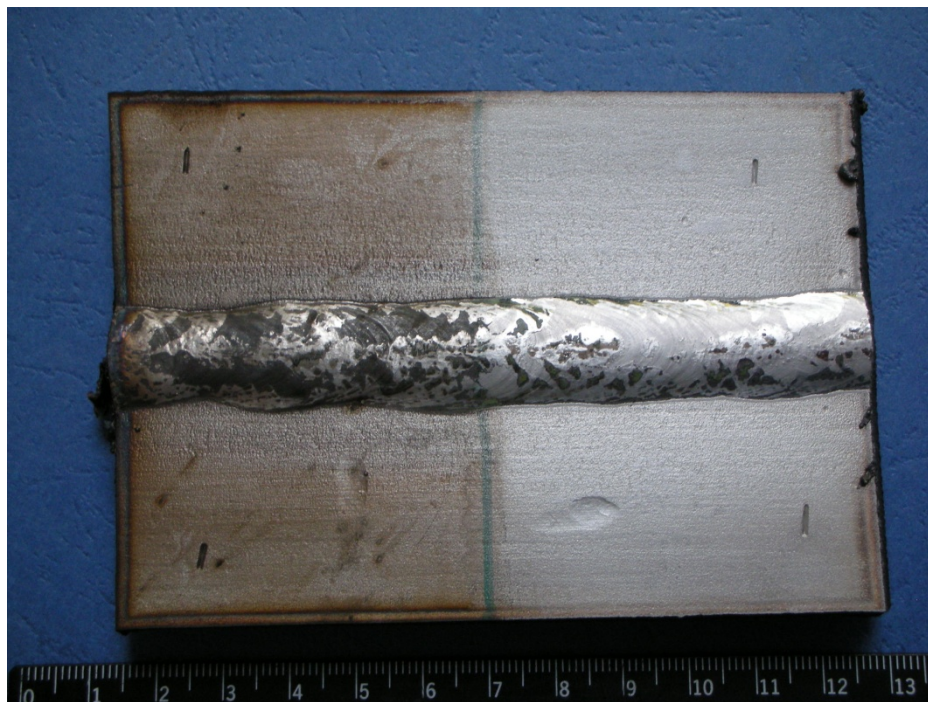
Slika 8.15. Uzorak I je sučeljeni spoj izveden MIG postupkom uz punu žicu.
