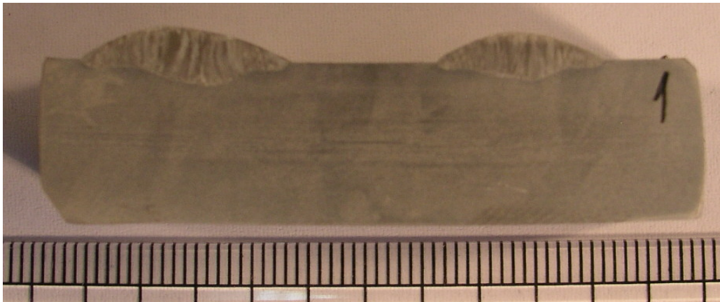
Slika 8.25. Prikaz makro izbruska broj 1, uzoraka E i F prikazuje navare dobijene FCAW-G postupkom uz PPŽ i različite struje navarivanja. Dobiveni navari su široki, ali dubina penetracije je mala. Vidi se oblik navara na kojeg znatno utječe zaštitni plin.
