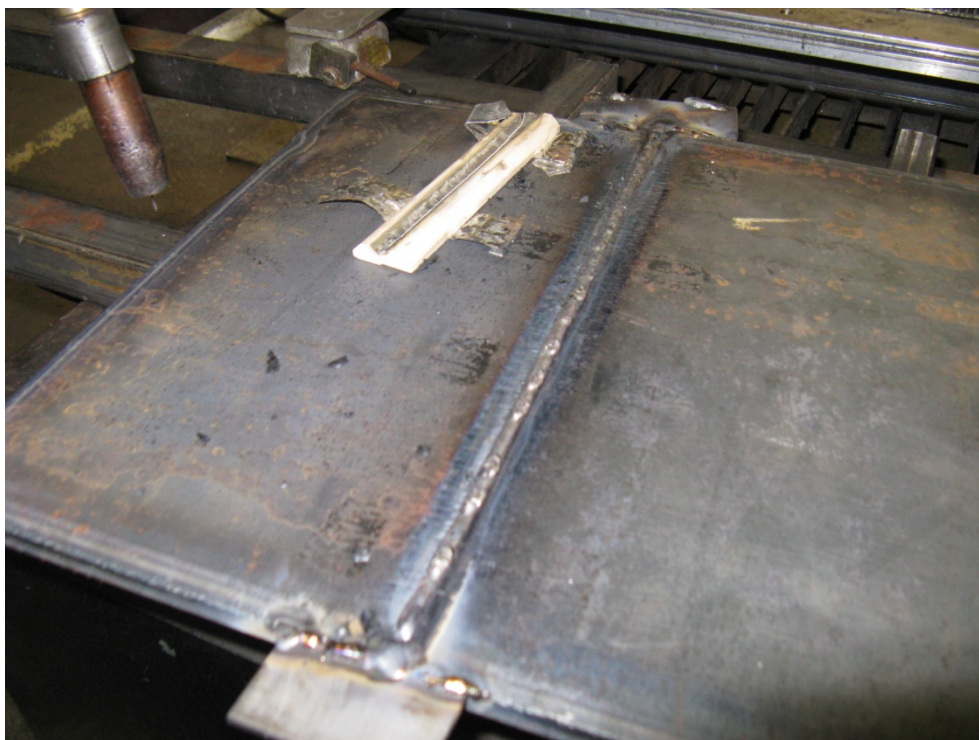
Slika 8.5. Prvi prolaz (korijenski) pri zavarivanju FCAW-G postupkom uz PPŽ i razmak u korijenu od 3 mm. Rezultat je zadovoljavajući, ali nema potrebnog nadvišenja zavara u korijenu, a prolaz zavara u donjem je dijelu procurio svakih par centimetara. Gornji dio (lice) zavara je vrlo dobro i slično u oba postupka (kako je prikazano na sljedećim slikama).
