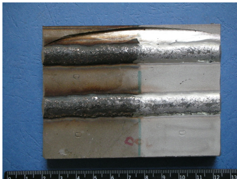
Slika 8.11. Navarene gusjenice oznake C i D (gornja je oznake C, a donja oznake D) izvedene na čeličnoj ploči uz struju zavarivanja I_z = 180 A; 235 A. Lijevi dio uzorka nije odmašćen i bajcan dok su ti postupci čišćenja izvedeni na desnom dijelu, kao što se i vidi.
