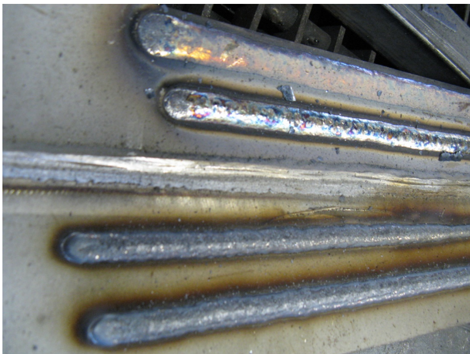
Slika 7.18. Izgled navarenih gusjenica, najdonja gusjenica je navarena uz punu žicu ( I_z = 235 A).
