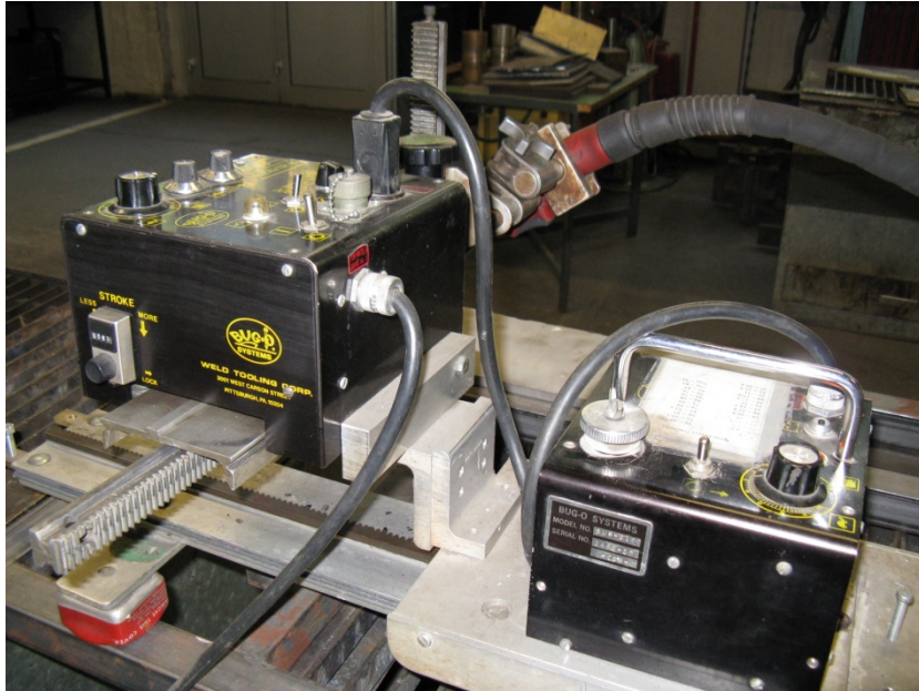
Slika 7.4. Uređaj automatskog posmaka pri zavarivanju, model Bug-5100, proizvođača Bug-O Systems; omogućava odabir brzine zavarivanja i njezino mijenjanje pri samom zavarivanju, kao i dodatne mogućnosti pri zavarivanju npr. njihanje zavarivačkog pištolja, odabir smjera zavarivanja,...
