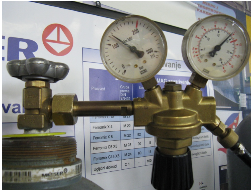
Slika 7.6. Manometar (lijevi indikator), protokomjer (desni indikator), regulator protoka (donji desni crni ventil) i ventil za otvaranje/zatvarenje plinske boce (gornji lijevi srebrni ventil) proizvođača Messer-Griesheim. Protok plina se određuje prema plinu koji ima veći udio u mješavini.
