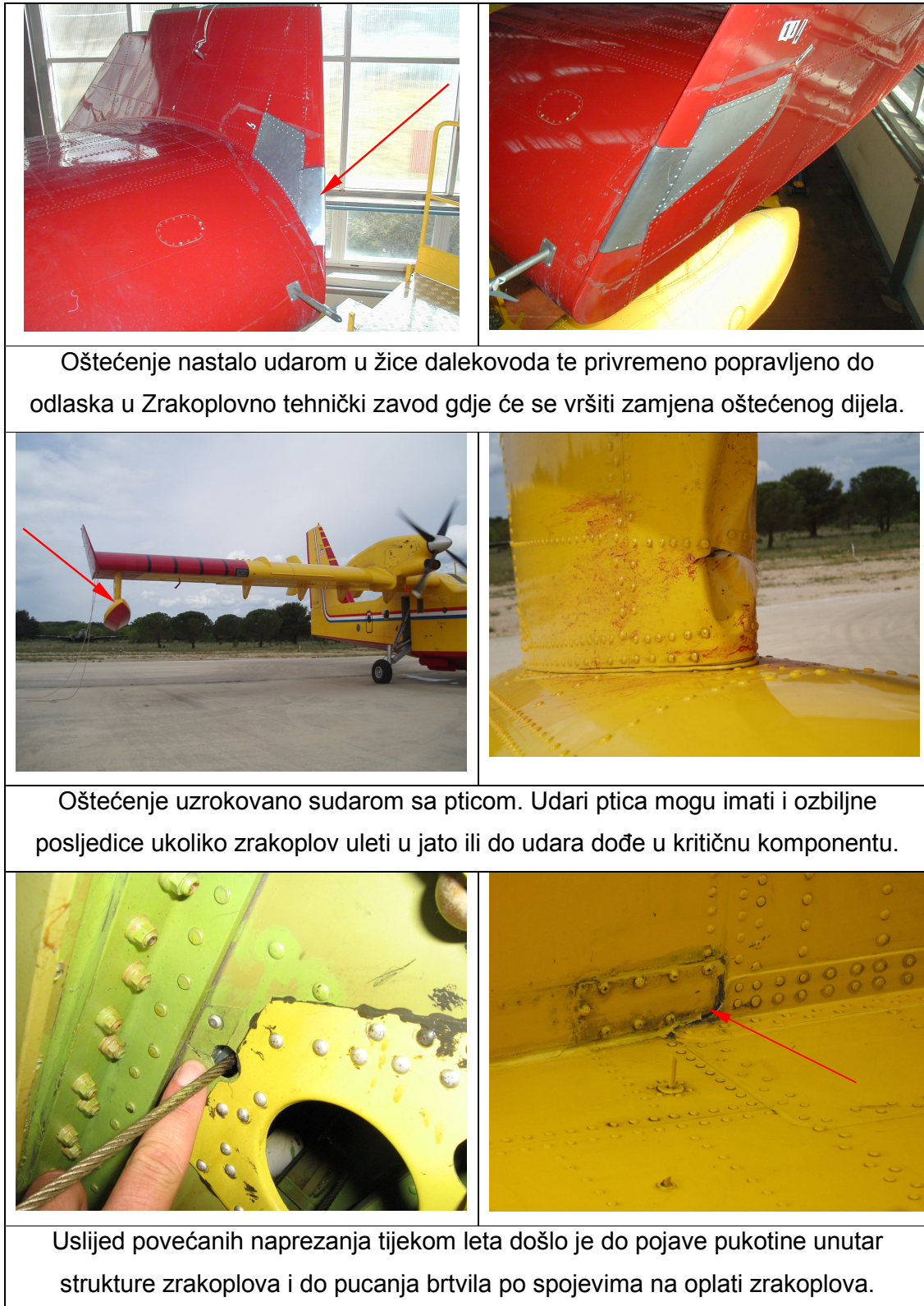
Slika 6-9 Oštećenja tijekom eksploatacije[21]
