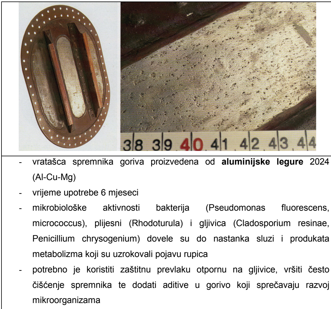
Slika 5-8 Vratašca zrakoplovnog spremnika goriva[7]
