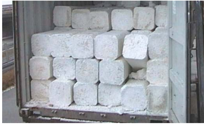
Slika 4.20 Utovarivanje blokova pjenastog polistirena [34]
