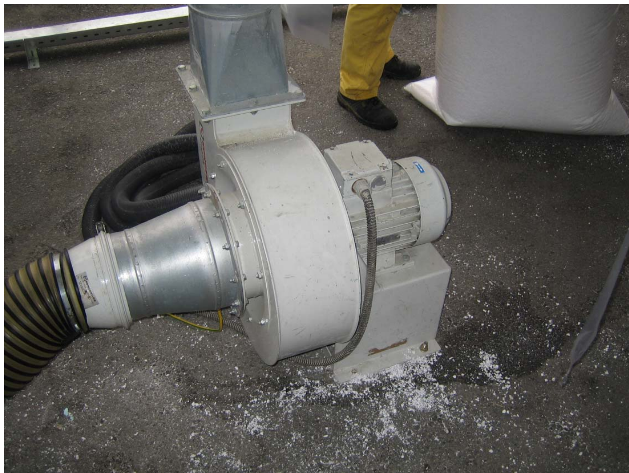
Slika 5.11 Ventilator za transport usitnjenog PS-E-a
