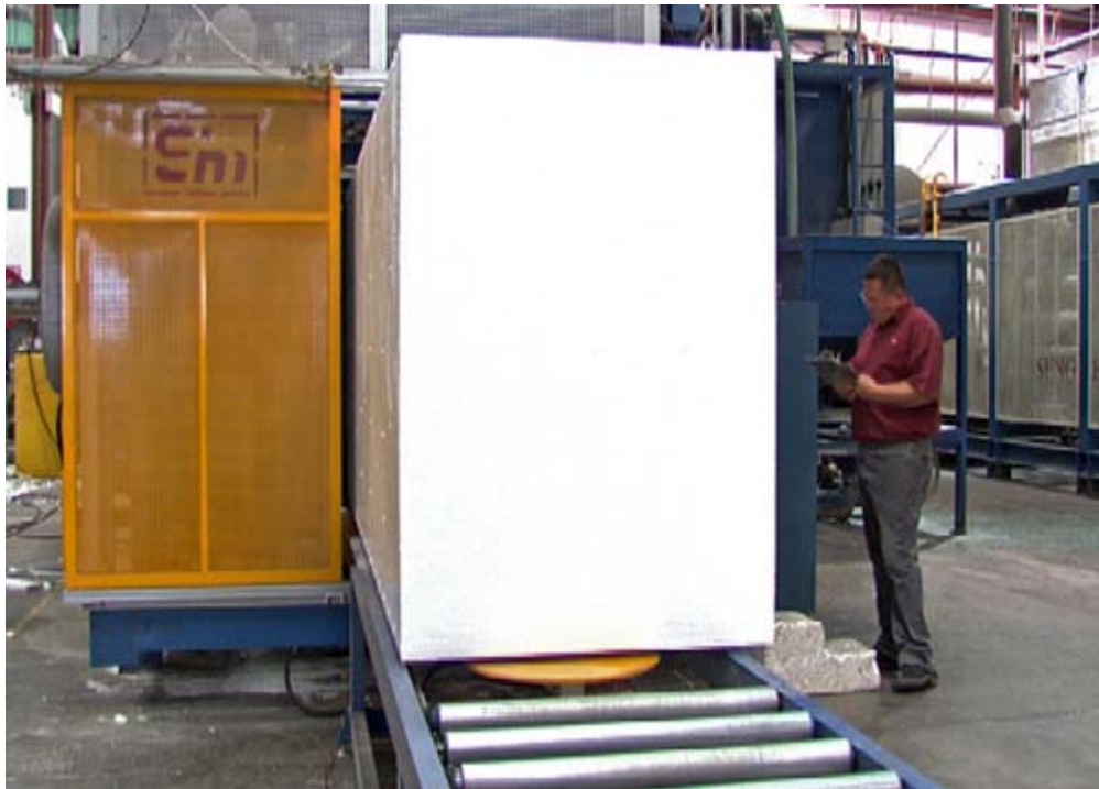
Slika 3.10 Kalupljenje u blokovima [12]
