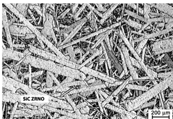
*Slika 5. Mikrostruktura grubozrnatog SSIC [2]*
