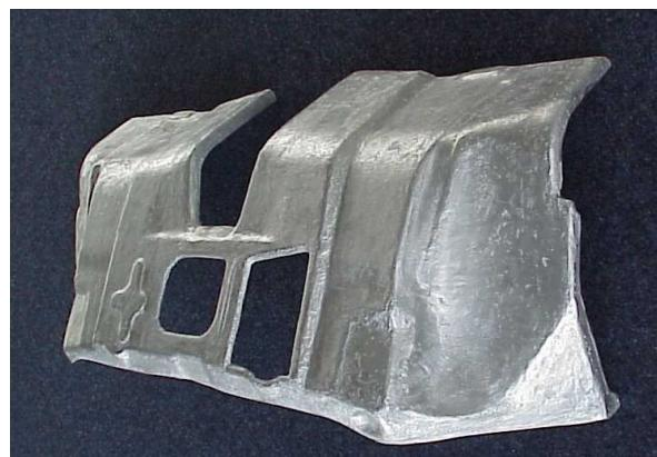
Slika 5.3. Pregrada između kabine vozila i motora vozila, izrađena od metalne pjene
