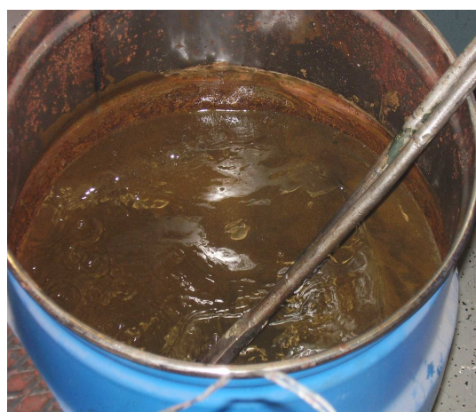
Slika 7.11. Posuda sa vodom u koju je uronjen izradak
