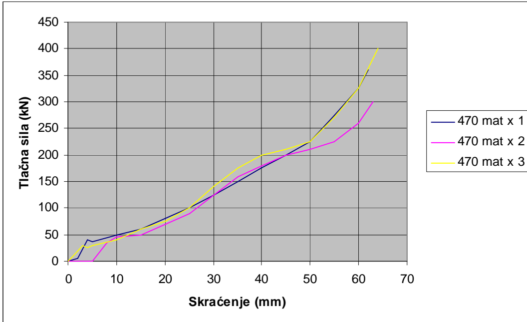
Slika 7.27. Dijagram tlačna sila – skraćenje za cilindrične uzorke 470 mat
