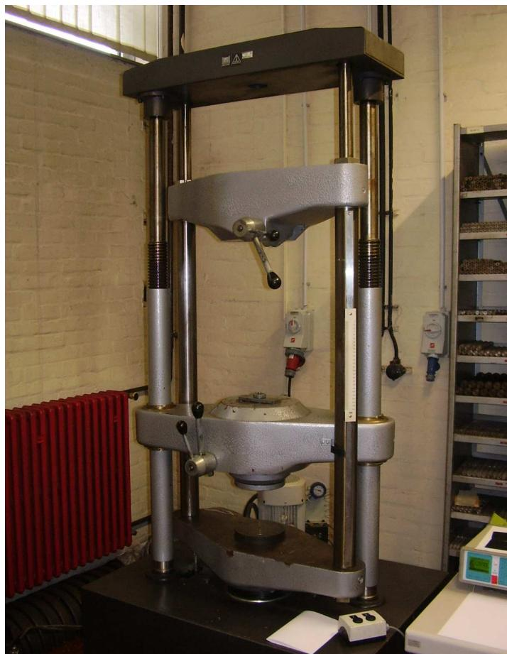
Slika 6.5. Kidalica u Laboratoriju za ispitivanje materijala (FSB Zagreb)
