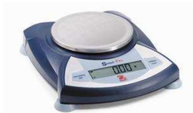
Slika 7.6. Vaga (Scout Pro) za mjerjenje mase prekursora
