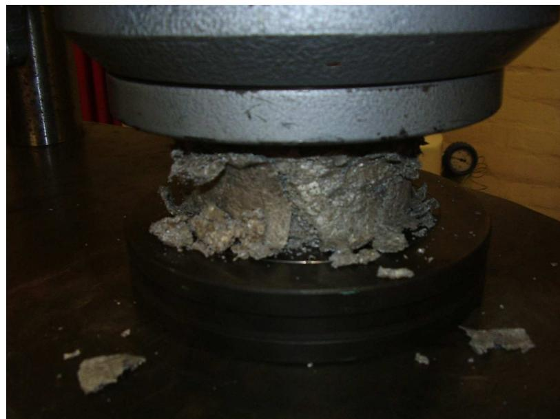
Slika 7.18. Cilindrični uzorak za vrijeme ispitivanja
