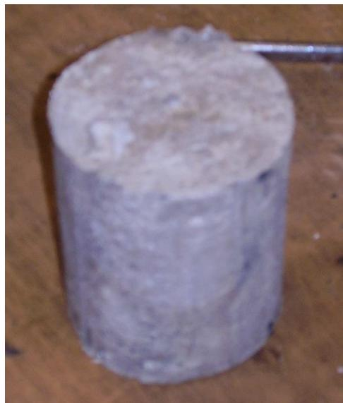
Slika 7.3. Uzorak aluminijске pjene izvađen iz kalupa
