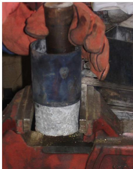
Slika 7.13. Izbijanje cilindričnog uzorka iz kalupa
