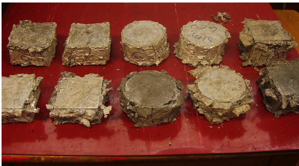
Slika 7.20. Uzorci nakon statičkog tlačnog pokusa
