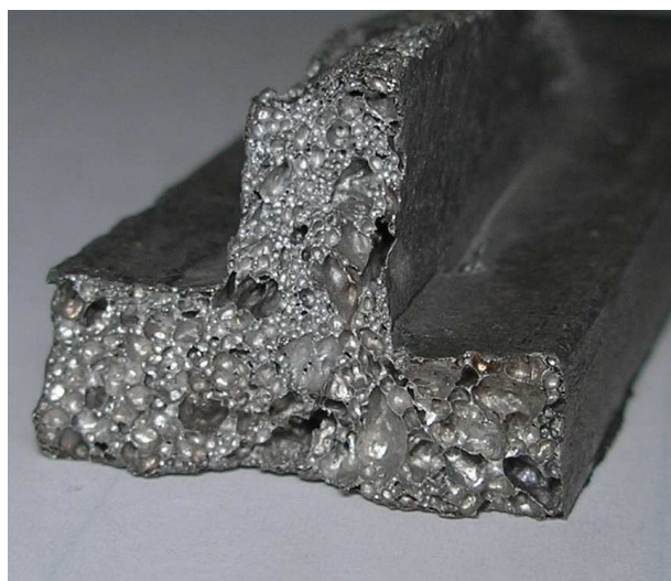
Slika 1.4. Profil izrađen od aluminijske pjene /5/
