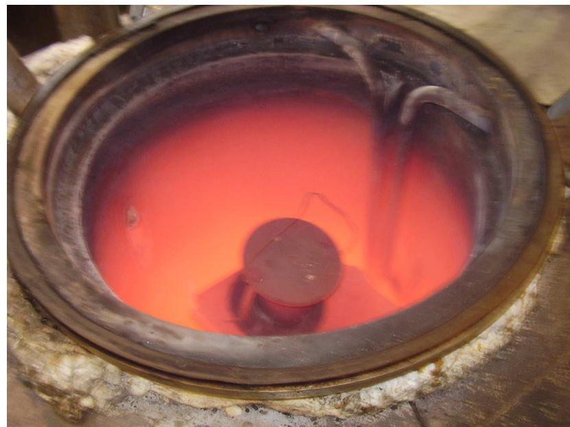
Slika 7.9. Kalup u peći zagrijanoj na 850 °C
