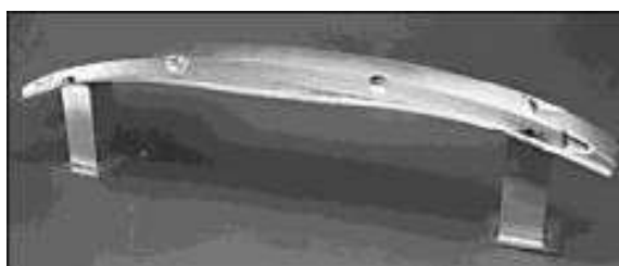
Slika 5.4. Branik automobila izrađen od aluminijske pjene /23/
