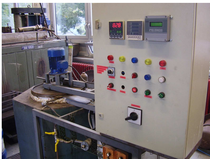
Slika 7.5. Elektrootporna peč (FSB, Zagreb)
