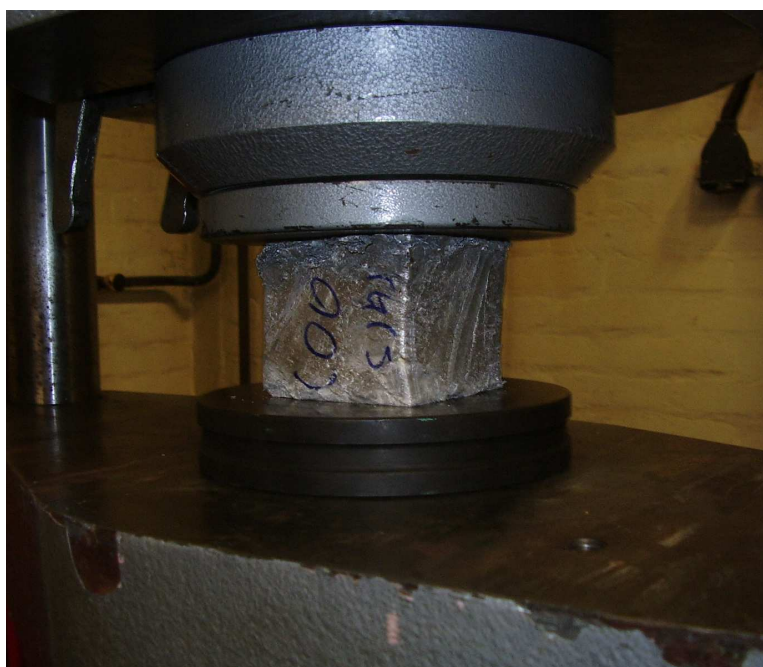
Slika 7.17. Kvadratni uzorak za vrijeme ispitivanja
