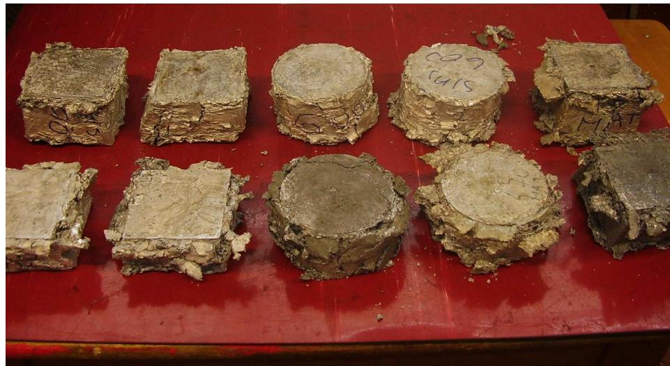
Slika 7.20. Uzorci nakon statičkog tlačnog pokusa
