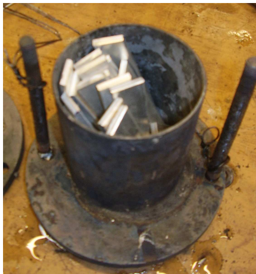
Slika 7.2. Čelična cijev pripravljena za kalupljenje
