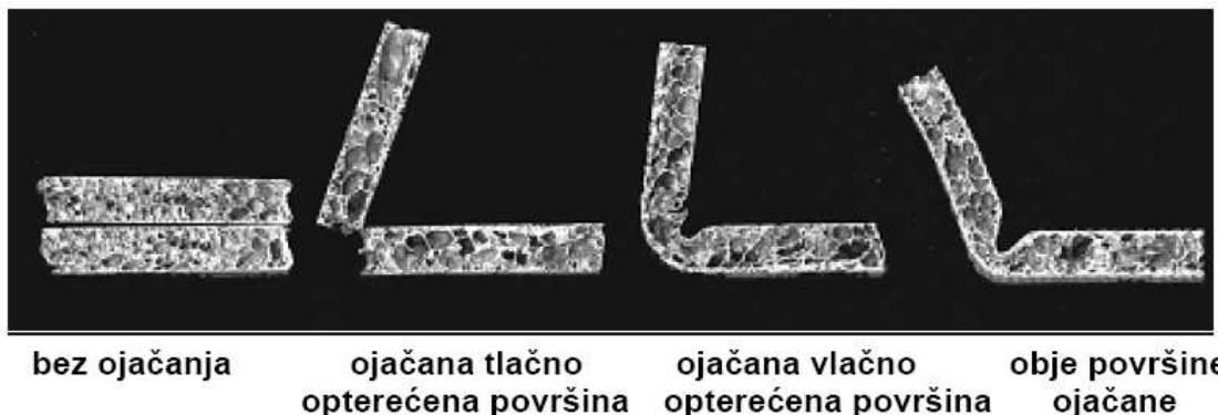
Slika 3.11. Ojačane Al pjene nakon udarnog opterećenja /18/
