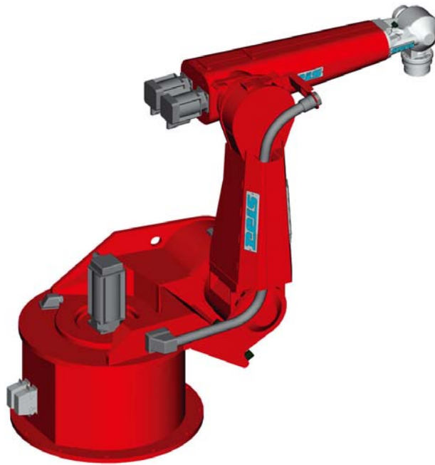
Slika 2.15. Robot za paletiziranje [8]
