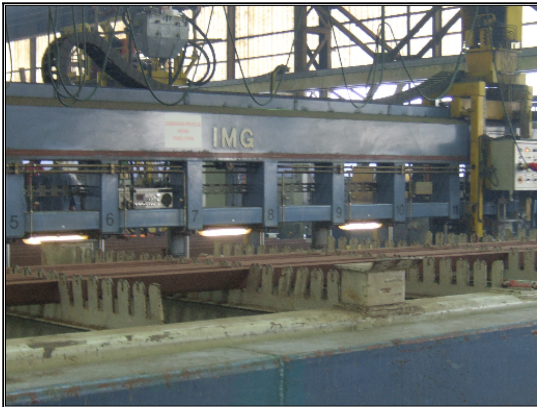
Slika 17. Uređaj za montažu i pripajanje ukrepa
