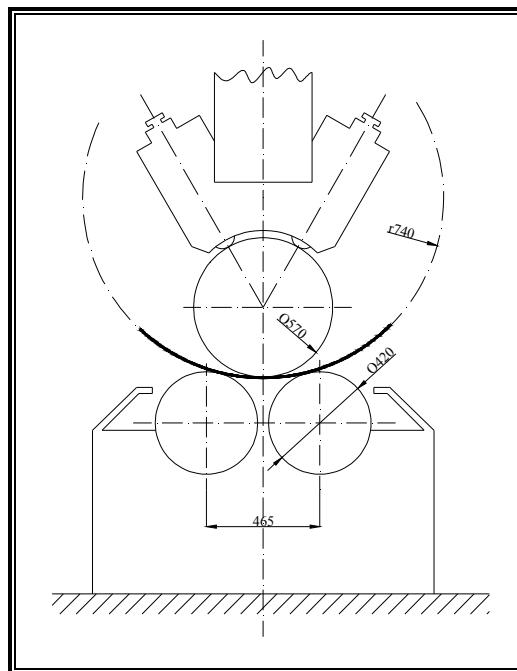
Slika 22. Poprečni presjek valjaka za savijanje limova
