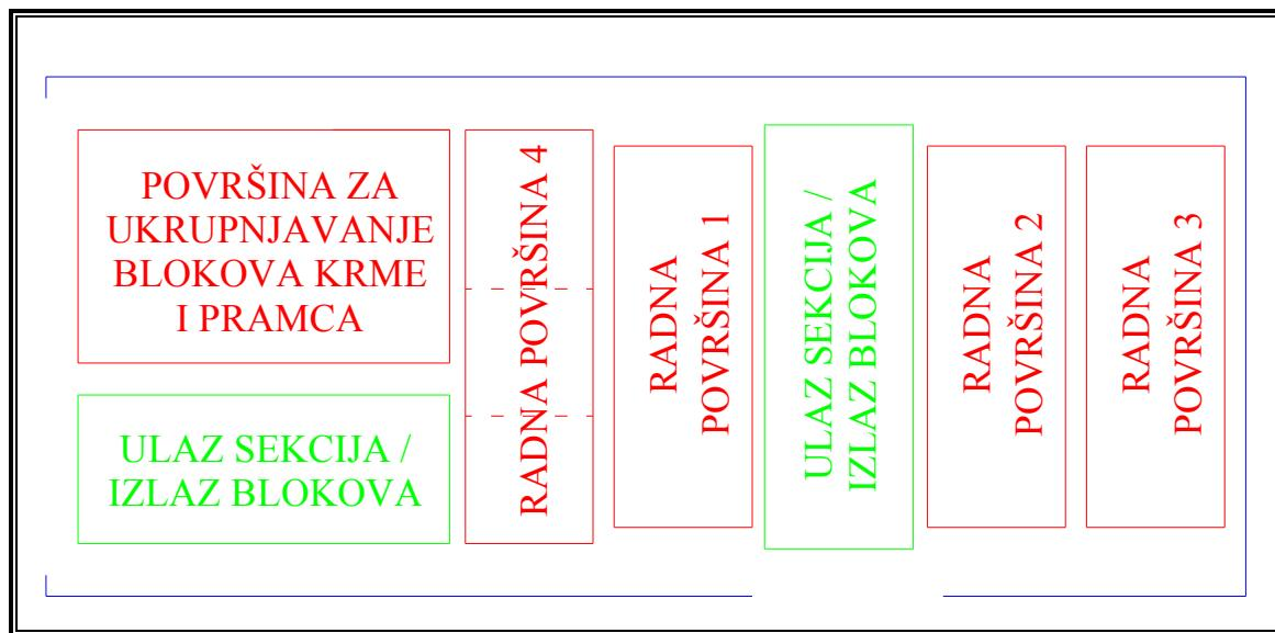
Slika 37. Raspored radnih površina unutar hale I
