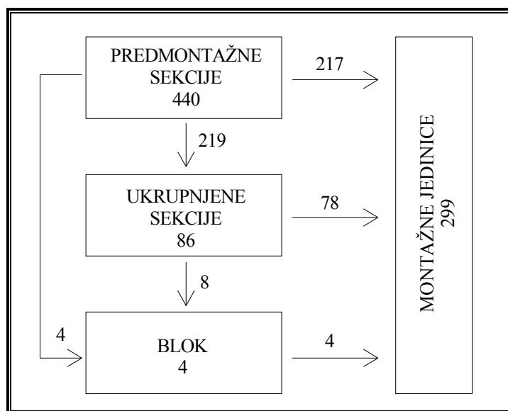
**Slika 2.** Dijagram toka izrade montažnih jedinica (gr. 472)
