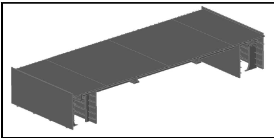
**Slika 64.** Blok treće palube sa dvobokom – blok 301
