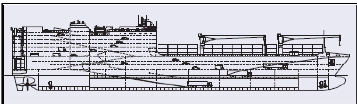
**Slika 3.** *Uzdužni presjek broda za prijevoz automobila, kamiona i kontejnera*
