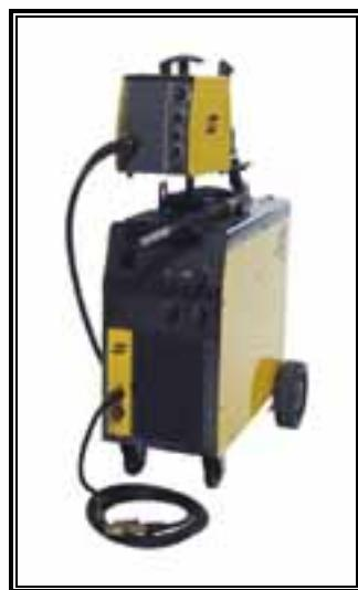
**Slika 56.** Aparat za zavarivanje MIG postupkom
