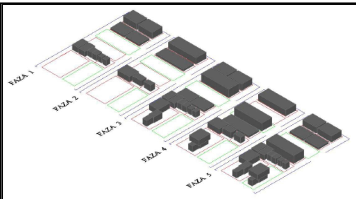
**Slika 39.** Shema izrade blokova na površini radionice
