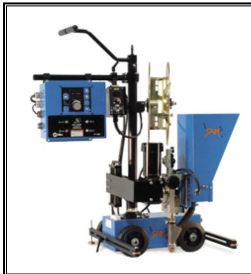
**Slika 69.** Poluautomatski uređaj za zavarivanje EPP postupkom
