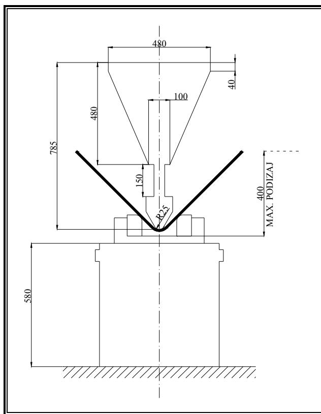
**Slika 23.** Poprečni presjek velike preše za savijanje limova
