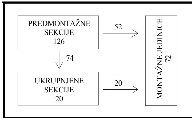
**Slika 5.** Dijagram toka izrade montažnih jedinica (gr. 480)
