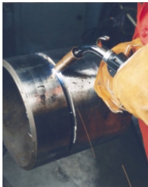
Slika 4.1 Primjer otvorenog korijena cijevi zavarenog STT postupkom, lijevo i sam postupak zavarivanja cijevi STT postupkom, desno [8]
