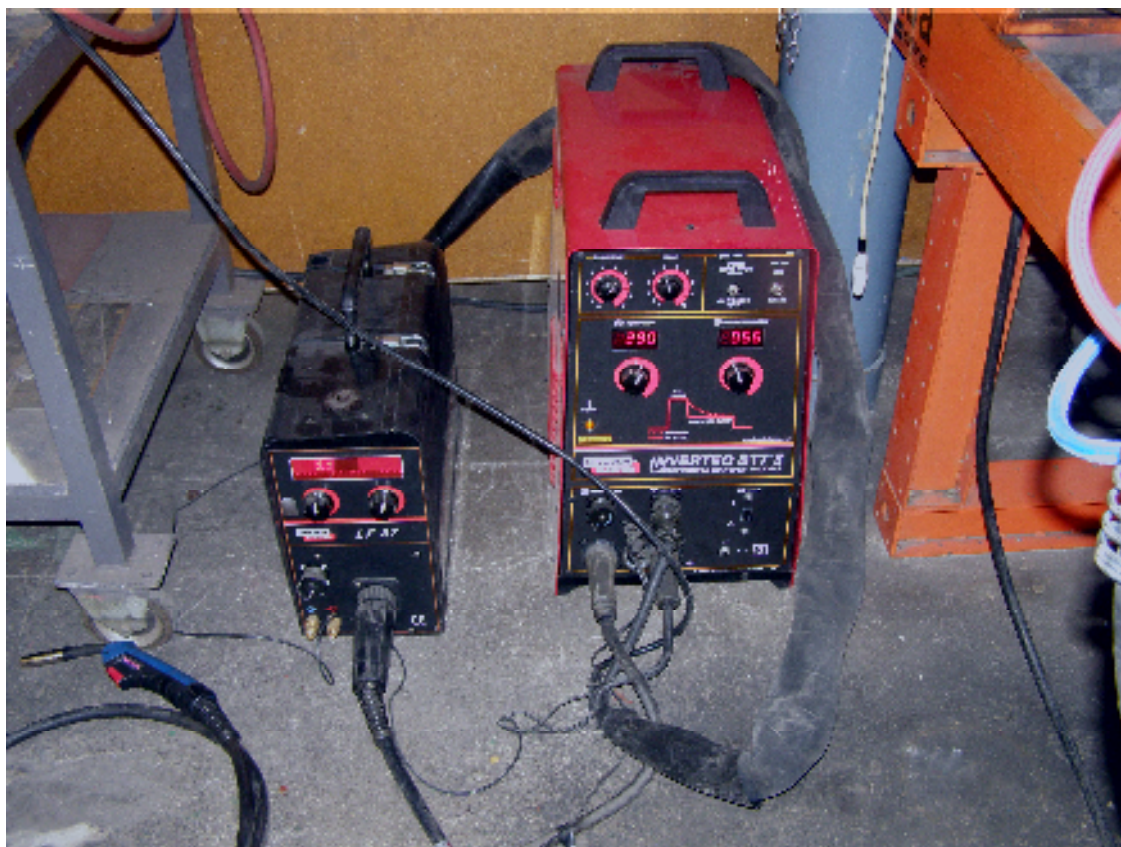
Slika 5.1 Uređaj za MAG-STT zavarivanje LINCOLN ELECTRIC STT II desno i dodavač žice LF 37 lijevo
