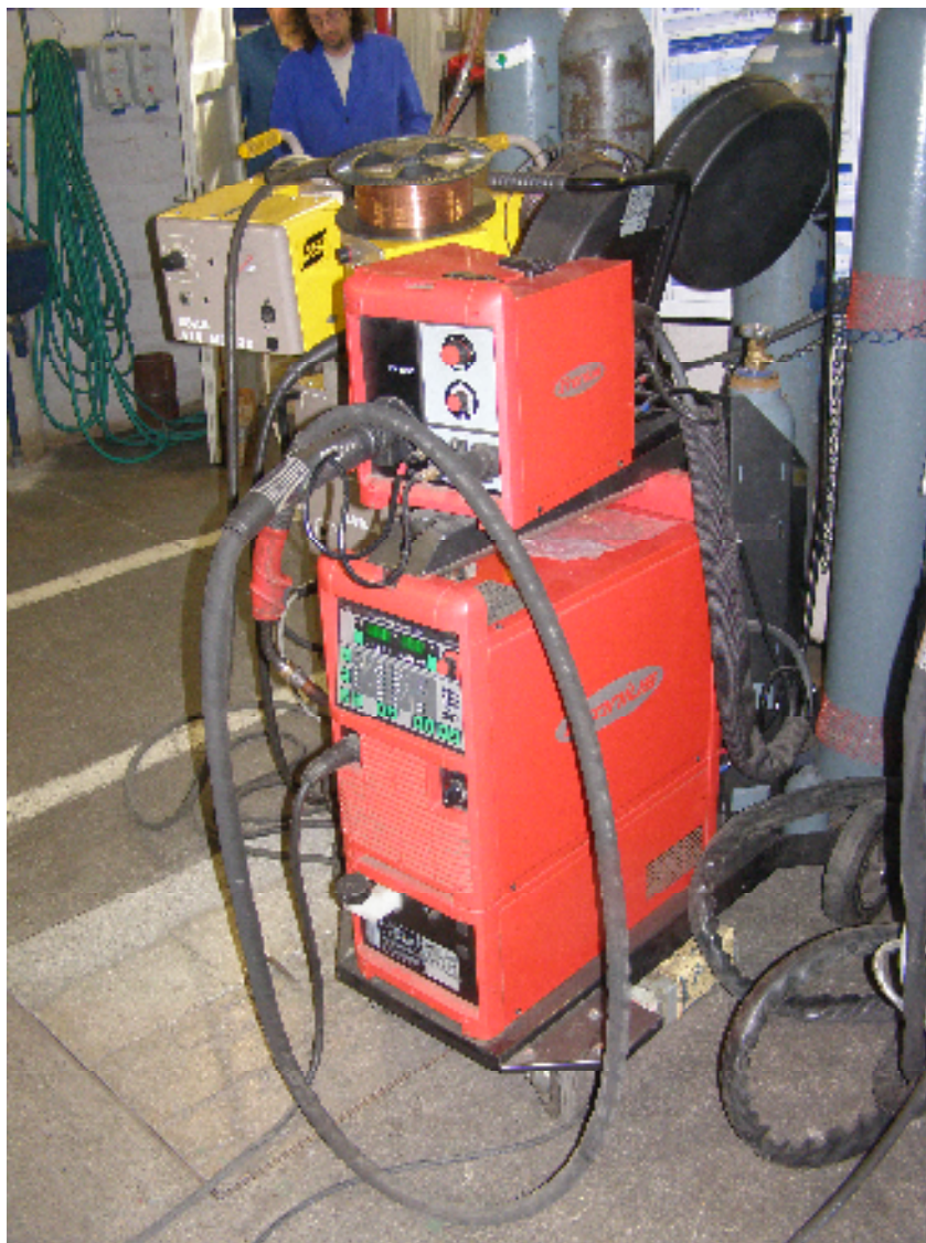
Slika 5.2 Uređaj za MAG zavarivanje FRONIUS TRANSPULSSYNERGIC 3200 sa dodavačem žice VR4000
