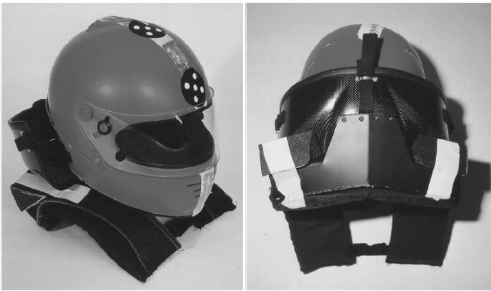
Slika 30. Ovratnik verzije 2.0 sa obrubljenim obručem i donjim dijelom ovratnika te dodanim mjestom uležištenja za pojas [6].
