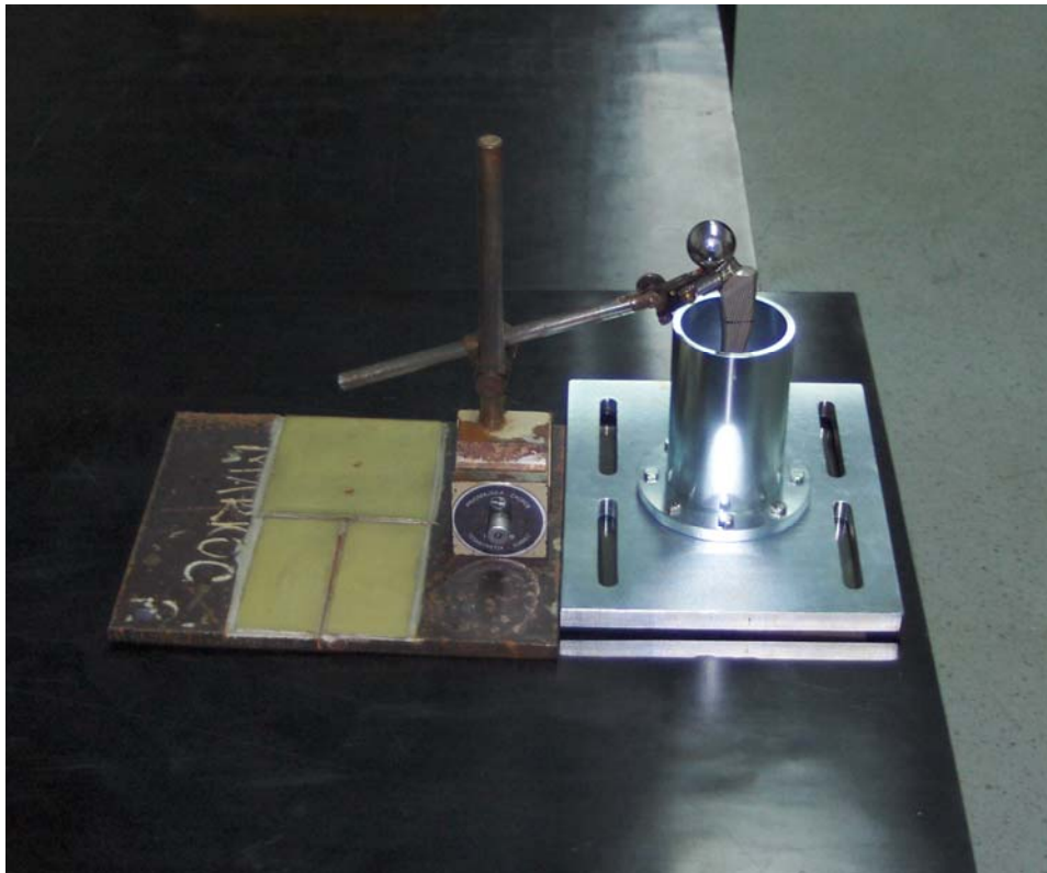
Slika 33. Pozicionirana endoproteza zgloba kuka na improviziranom stalku
