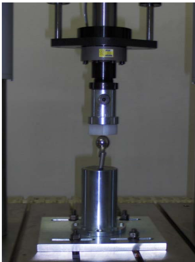
Slika 34. (A) Kolinearost centra glave endoproteze i osi opterećenja dinamičke kidalice
