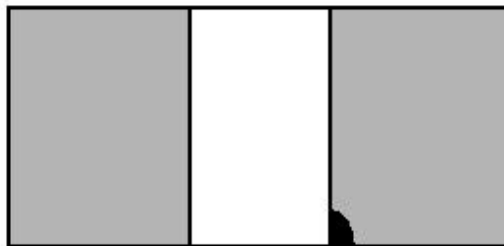
Slika 3.28. Propagacija nakon godine dana u zadanom režimu vožnje, a=4 mm i c=3 mm
