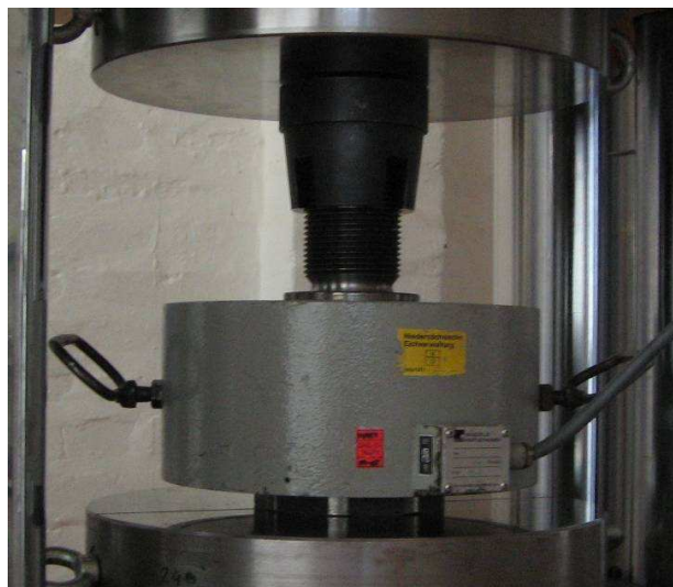
Slika 15: Posrednički etalon Z4 500 kN pri umjeravanju referentnog etalona LIMS - a
