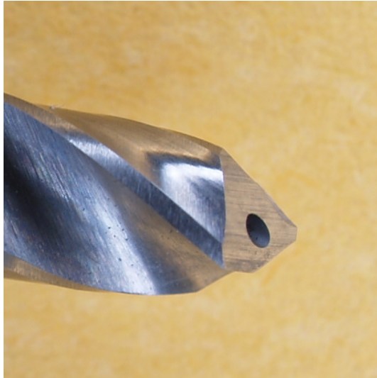
Slika 83. Oštrica prvog stupnja dvostupnjevanog spiralnog svrdla promjera 3,4-4,5 mm prije mjerenja
