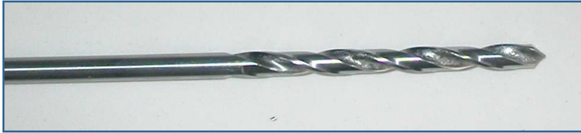
Slika 35. Standardno spiralno svrdlo u traumatologiji [21]
