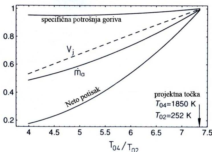
Slika 7-5. Performanse motora za slučaj 2., kao funkcija  $T_{04}/T_{02}$  pri projektnim vrijednostima
