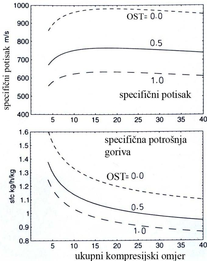
Slika 6-1. Prikaz promjene specifičnog potiska i potrošnje goriva u ovisnosti o ukupnom kompresijskom omjeru s odabranim omjerom sekundarnog toka za  $Ma=0.9$
