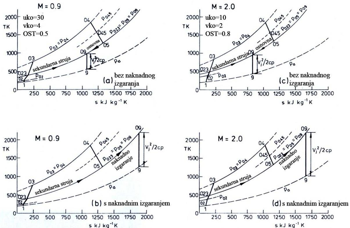
Slika 5-7. Termodinamički ciklus turbomlaznih motora (uko-ukupni kompresijski omjer, vko-ventilatorski kompresijski omjer, OST- omjer sekundarnog toka)
