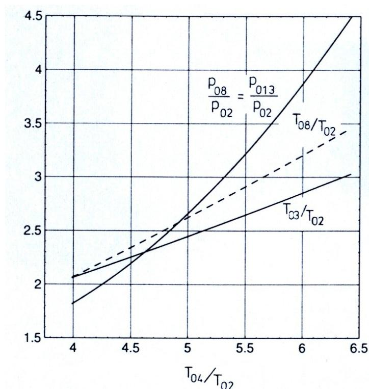
Slika 7-6. Prikaz temperaturnih i kompresijskih omjera za slučaj 1. kao funkcija  $T_{04}/T_{02}$
