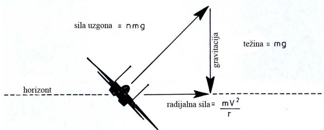
Slika 4-1. Prikaz glavnih aerodinamičkih sila na zrakoplov u zaokretu
