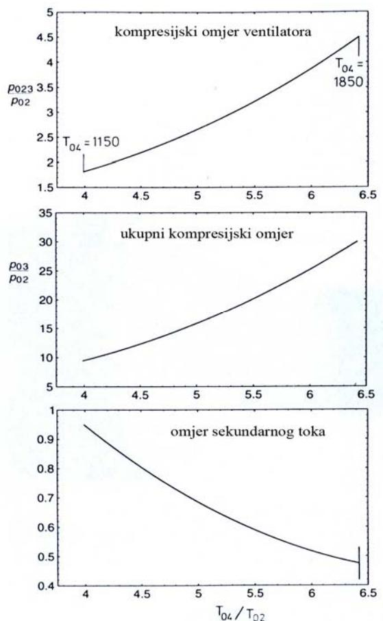
Slika 7-3. Ovisnost kompresijskih omjera o temperaturnom omjeru  $T_{04}/T_{02}$
