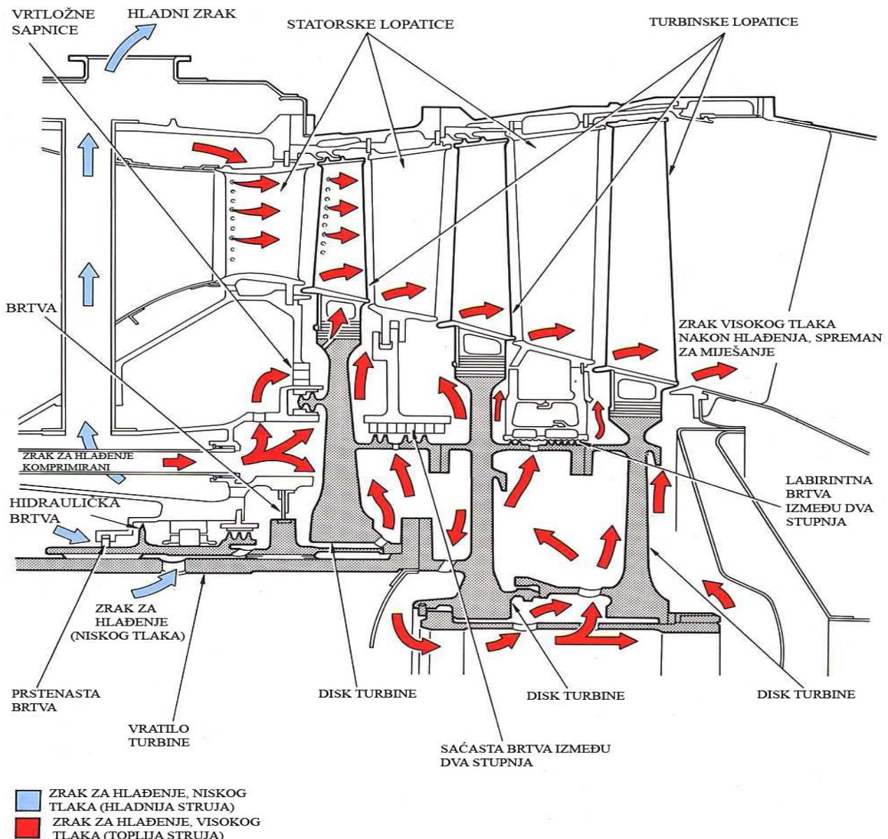
Slika 6-7. Prikaz sustava za hlađenje turbineskog sklopa [5]
