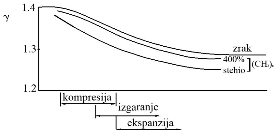
Slika 5-3. Promjena  $\gamma$  tijekom procesa mlaznog motora [3]
