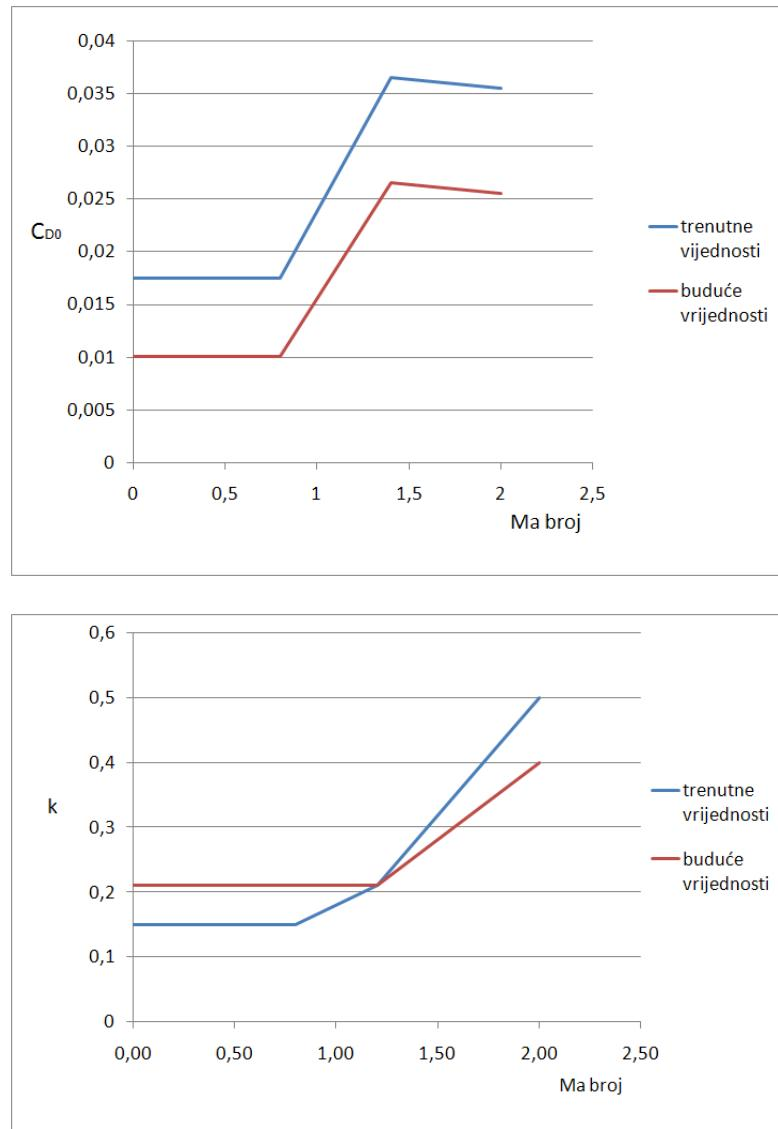
Slika 4-2. Prikaz vrijednosti  $C_{D0}$  i  $k$  u ovisnosti o Ma broju
