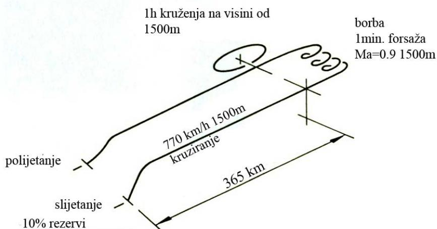
Slika 3-1. Tipična misija borbenog zrakoplova visokih performansi
